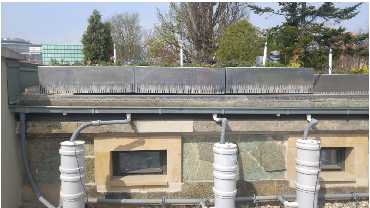
Abbildung 11 Felder FI.1 bis FI.3 mit Lysimeter und CTD-Sonden
