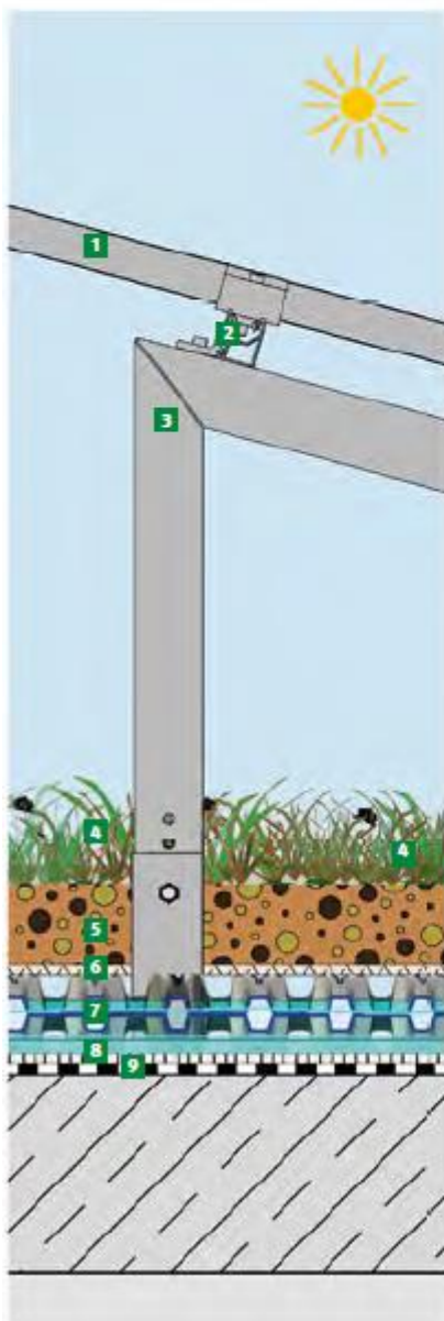
Anhang 14 - Schichtaufbau Solargründach (WRB)
