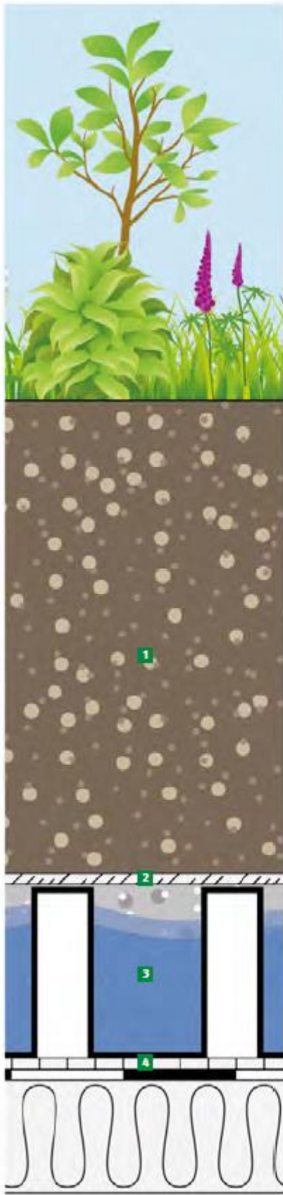
Anhang 10 - Schichtaufbau Gartendach
