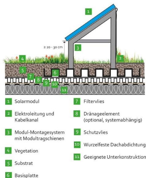
Abb. 23 - Systemaufbau Solargründach
