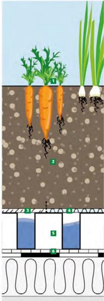
Anhang 11 - Schichtaufbau Gartendach ("Urban Farming")
