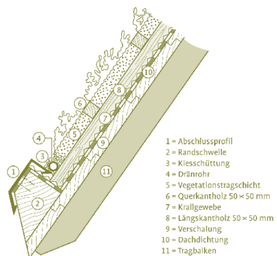
Abb. 4 - Dachaufbau begrüntes Steildach
