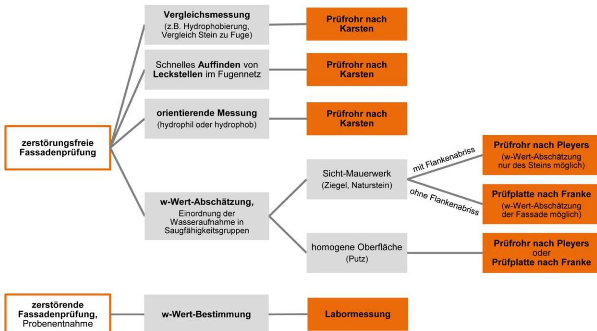
Bild 18 Entscheidungshilfe zur Auswahl einer geeigneten in-situ w-Wert-Messmethode
