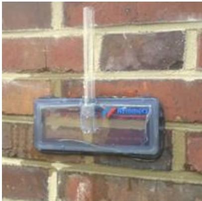
Bild 25 Prüfplatte nach Franke, Messung von Stein- und Fugenanteil
