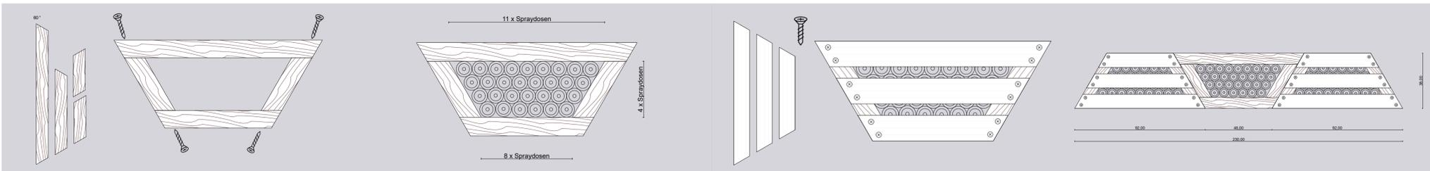
Die modulare Treppe bildet das Entrée der ständigen Vertretung. Eine Unterkonstruktion hält trapezförmige Module zusammen.
