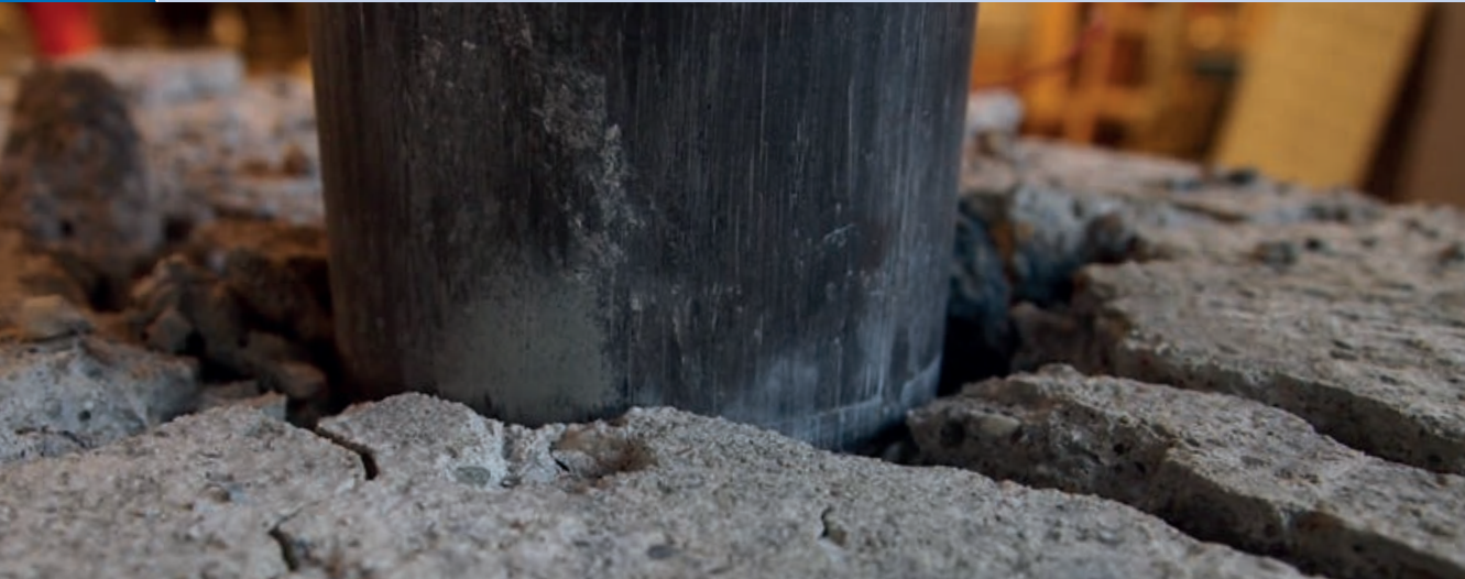
Schädigung eines Quaders an der Oberseite nach Impakteinwirkung | Damage of a concrete cuboid at the surface after impact | Photo: Lena Leicht
