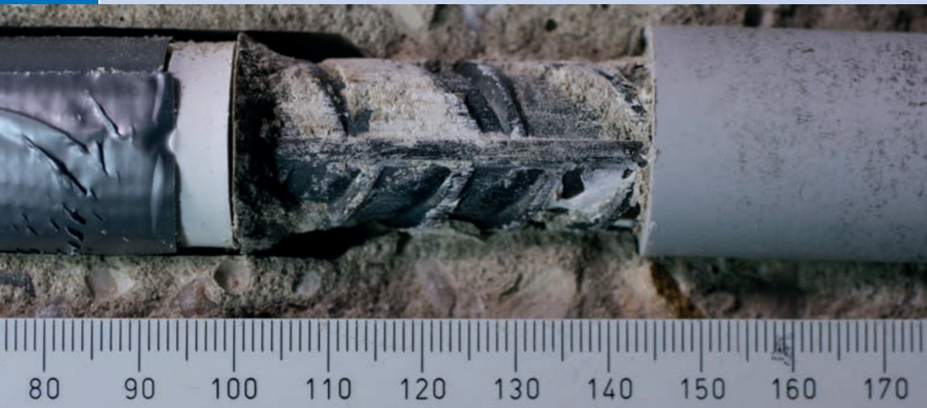
Verbundbereich nach Versagen | Bond zone after failure | Photo: Marc Koschemann
