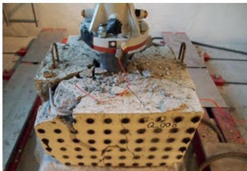
Quader ohne Dämpfungsschicht nach einem Impaktversuch im Fallturm | Cuboid without damping layer after an impact experiment in the drop tower | Photo: Lena Leicht
