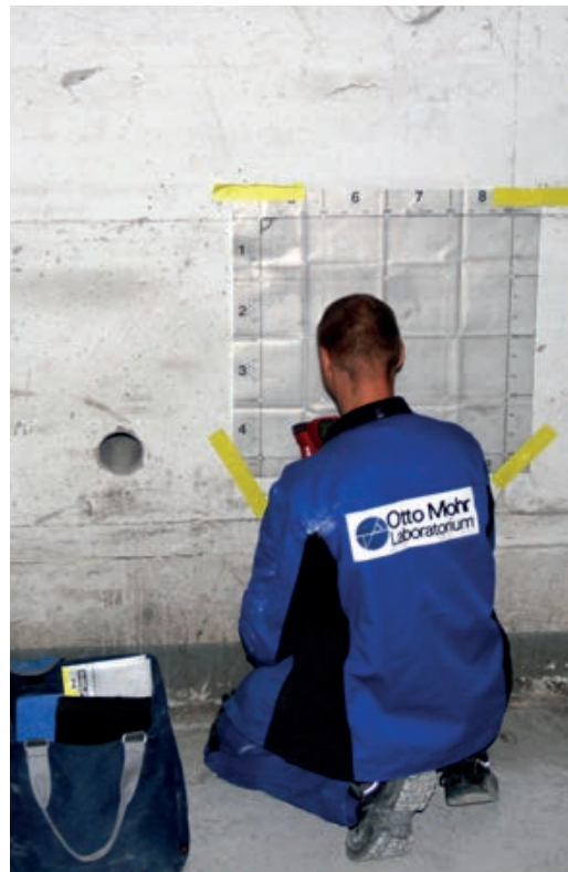
Durchführen eines Bewehrungsscans bei einer Stahlbetonwand | Scanning of a reinforced concrete wall | Photo: Sabine Wellner
