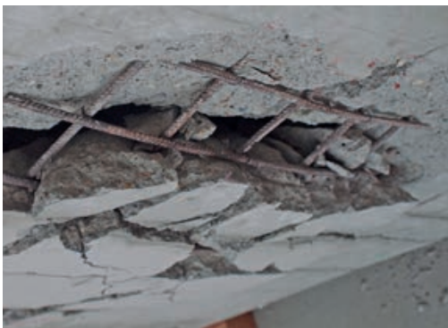
Unterseite eines Probekörpers nach dem Impaktexperiment | Bottom side of a specimen after the impact experiment | Photo: Marcus Hering
