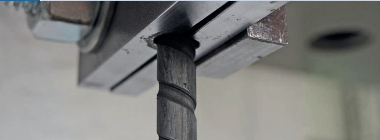
Detailaufnahme eines Carbonstabes im Zugschwellversuch | Close-up of a carbon rebar under cyclic tensile load | Photo: Juliane Wagner
