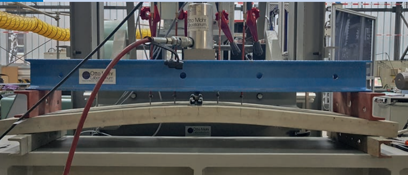
Bestimmung der Auszugskraft einer neuartigen Montageschiene | Determination of the pull-out force of a novel joint technology | Photo: Dominik Schlüter
