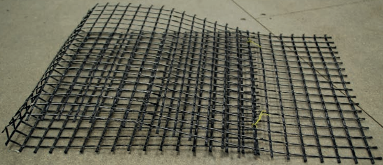
Gefaltete Carbonbewehrung zur Verbesserung des Tragverhaltens | Folded carbon reinforcement to improve load-bearing behaviour | Photo: Lenne Grundmann
