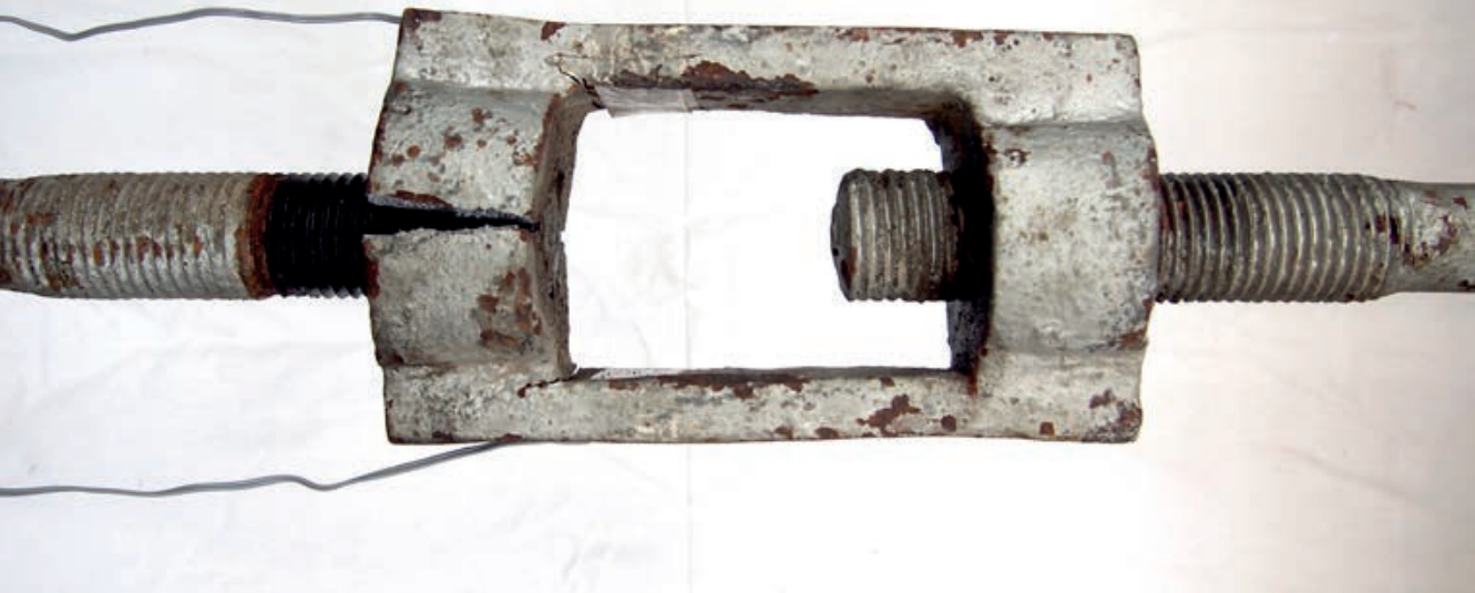
Versagensbild des Spannschlusses 2 | Failure pattern of the turnbuckle number 2 | Photo: Silke Scheerer
