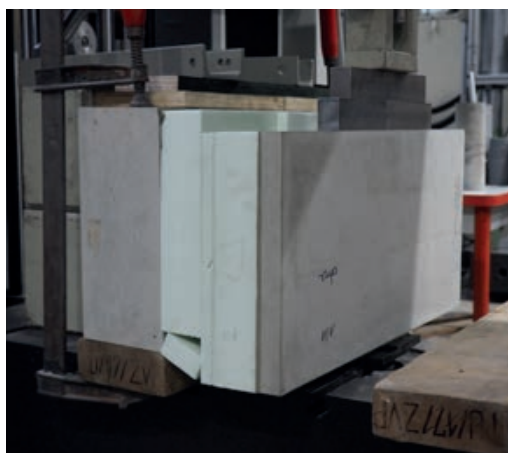
Ein Teildemonstrator im Schubversuch | A part of a double wall during shear testing | Photo: Juliane Wagner
