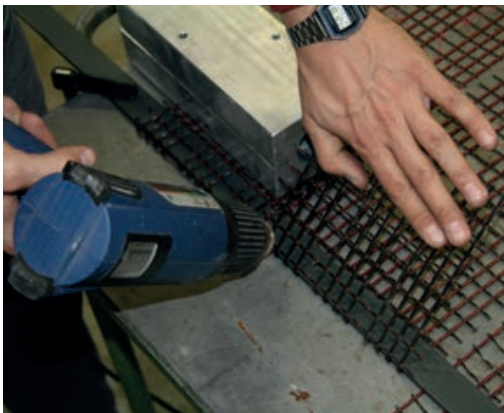
Umkappen des Geleges im Endbereich zur mechanischen Verankerung mittels Thermoformen | Folding down the grid in the end area for mechanical anchoring by thermoforming | Photo: Maximilian May
