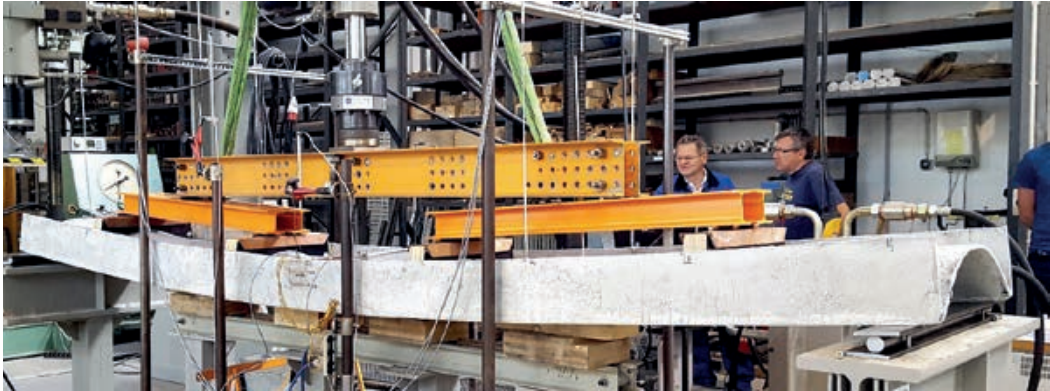
6-Punkt-Biegeversuch bei einem ungefüllten, 4,5 m langen Deckenelement | 6-point bending test on an unfilled, 4.5 m long ceiling element | Photo: Tilo Senckpiel-Peters
