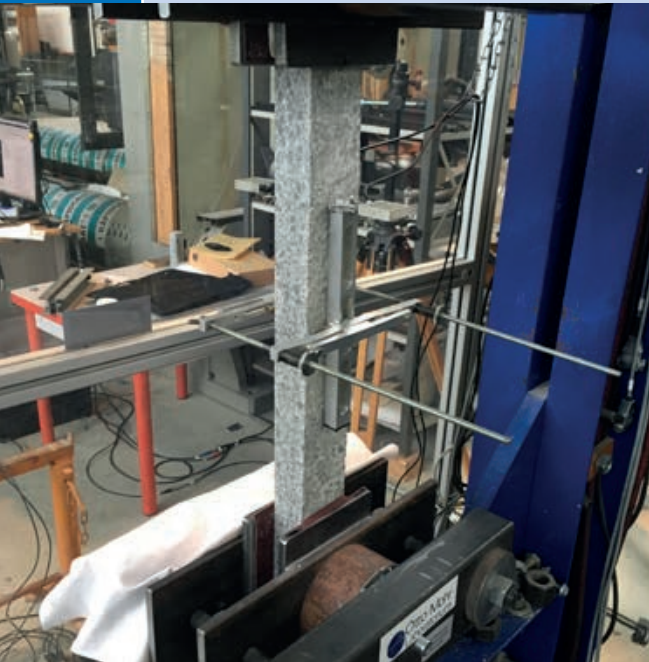
Statischer Versuchsaufbau mit Dehnkörper | Static test set-up with a tension-strain test element | Photo: Enrico Baumgärtel
