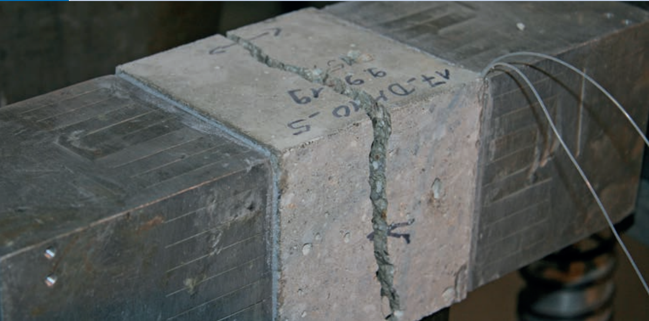
Ermittlung der Zugfestigkeit zur Charakterisierung der Gefügeschädigung | Determination of the tensile strength to characterise the structural deterioration | Photo: Kerstin Speck
