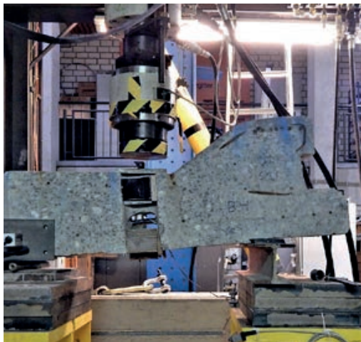
Prüfkörper im Drei-Punkt-Biegeversuch | Specimen before three-point bending test | Photo: Dominik Mielke
