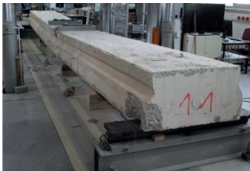
Belastungsversuch an einem Einzelträger im Otto-Mohr-Laboratorium | Load test on a single beam in the Otto-Mohr-Laboratory | Photo: Oliver Steinbock
