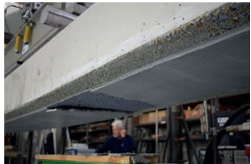
Balken mit kombinierter Stahl- und Carbonbewehrung im Biegeversuch | Foto: Niclas Oette
