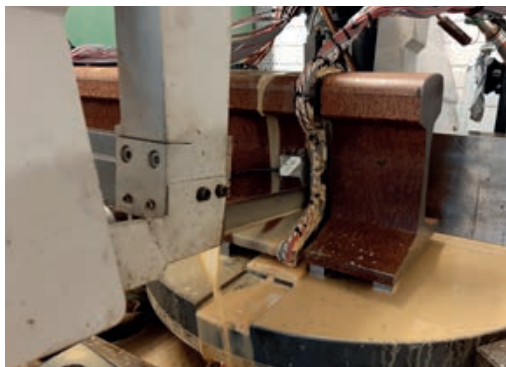
Eigenspannungsmessungen mit Schnittmethode | Residual stress measurement with sectioning method | Photo: Chongjie Kang
