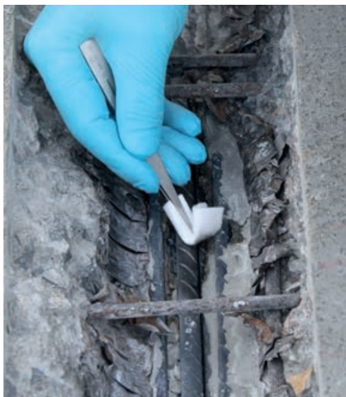
Reinigen des Stahls vor dem Applizieren eines Dehnmessstreifens | Cleaning the steel before applying a strain gauge | Photo: Sabine Wellner
