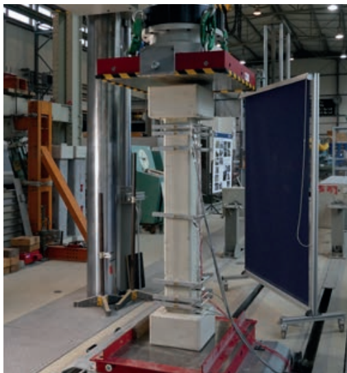
Versuche mit verstärkten Stützen | Tests with columns, strengthened with CRC | Photo: Zuhair Amer
