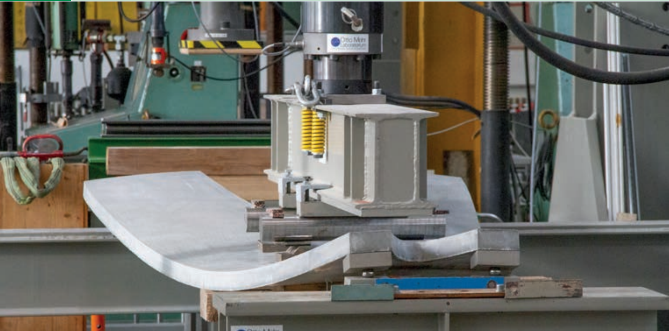
4-Punkt-Biegeversuch einer Stütze der Carbonbetonbrücke für das Deutsche Museum München | 4-point bending test of a prop of the carbon concrete bridge for the "Deutsches Museum München" | Photo: Stefan Gröschel
