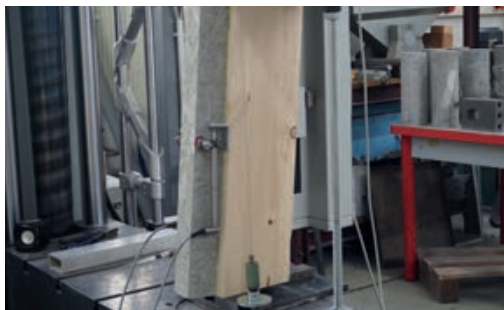
Druck-Scher-Versuch am Holz-Beton-Verbundkörper | Compression-shear test on a wood-concrete composite body | Photo: Melchior Deutscher
