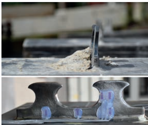
Versagensmodus und DMS-Applikation für einen Abscherversuch in Dübel-Querrichtung | Failure mode and arrangement of strain gauges for a push-out test in transverse direction | Photo: Cécilia Karge
