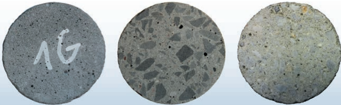
Untersuchung unterschiedlicher Festigkeitsklassen; links: UHPC, Mitte: HPC und rechts: Normalbeton | Investigation of different concrete strength; left: UHPC, center: HPC and right: NC | Photo: Melchior Deutscher
