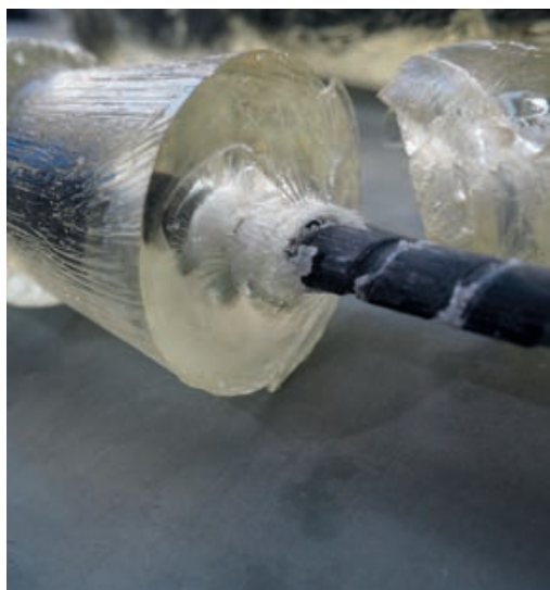
Für die Ermüdungsversuche musste eine geeignete Lasteinleitung gefunden werden – hier einer der ersten Tastversuche | One of the first tests on finding an appropriate load introduction for the fatigue tests | Photo: Juliane Wagner
