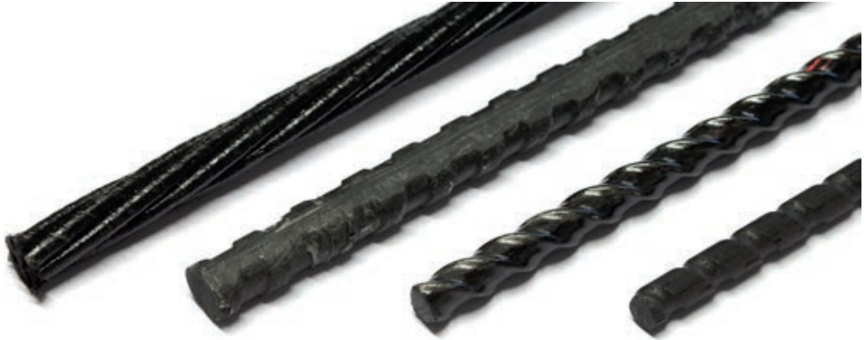
Verschiedene Geometrien von Carbonstäben | Foto: Sven Hofmann
