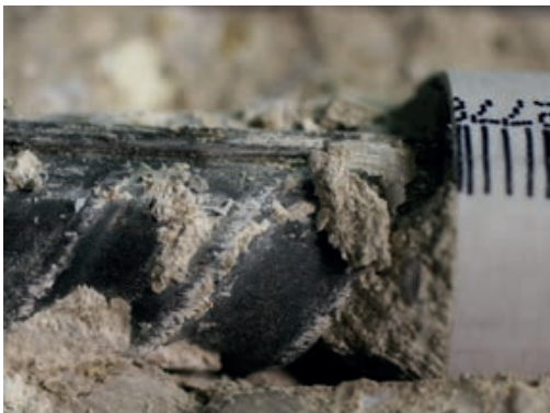
Verbundzone mit Sensorfaser nach Versagen | Bond zone with sensor fibre after failure | Photo: Marc Koschemann
