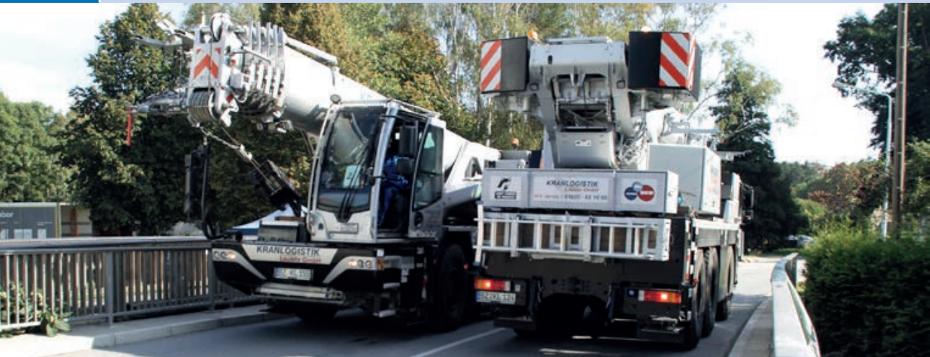
Belastungsfahrzeuge auf der Brücke im Rahmen der Probebelastung | Loading vehicles on the bridge within the load test | Photo: Oliver Steinbock
