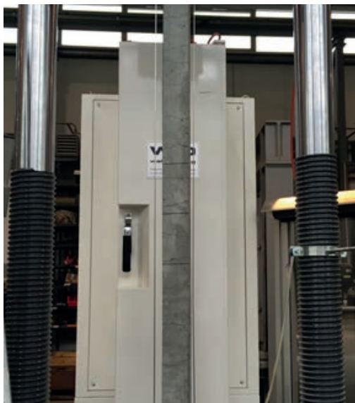
Dynamischer Versuchsaufbau mit Dehnkörper | Dynamic test set-up with a tension-strain test element | Photo: Enrico Baumgärtel
