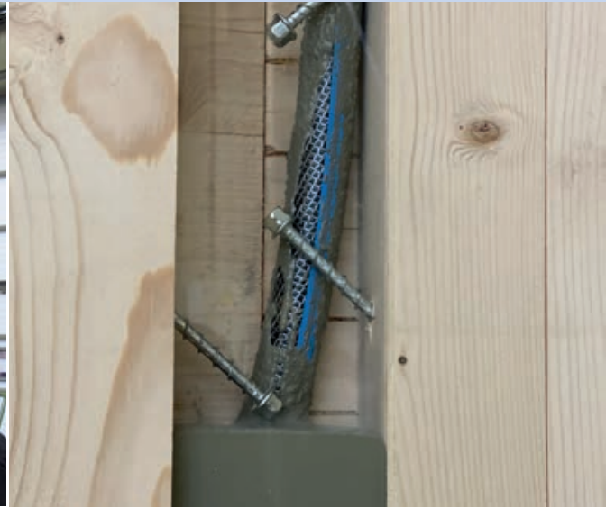
Herstellungstechnologie bei innenliegender Betonnut zur Verbindung zweier Brettsperrholzwandelemente (zur Beobachtung durch Plexiglas-scheibe) | Production technology with internal concrete groove for connecting two cross laminated timber wall elements (for observation through Plexiglas pane) | Photo: Kristina Farwig
