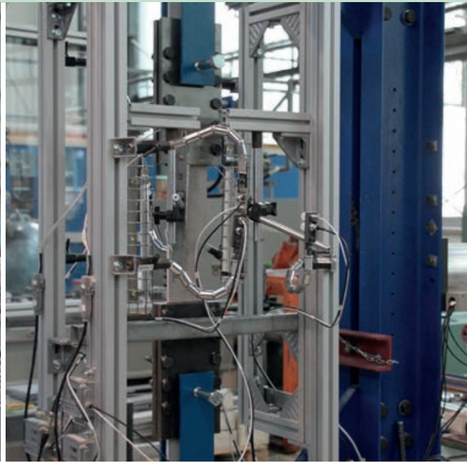
Zugversuch im Biaxrahmen mit Heizstand (links), Flachprobe im offenen Heizstand (Zugversuch, rechts) | Tensile test in biax frame with heating stand (left), flat sample in open heating stand (tensile test, right) | Photos: Frank Naumann
