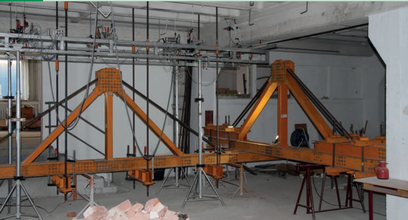
Rahmenkonstruktion zur Lasteinleitung | Frame construction for load transfer | Photo: Sabine Wellner
