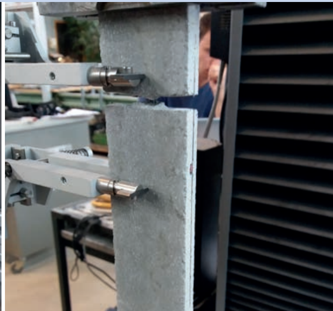
Dehnkörperversuche (links) und Kurzzeitauszugsversuche zur Qualitätssicherung (rechts) | Tensile tests (left) and short-term pull-out tests for quality control (right) | Photos: Zuhair Amer
