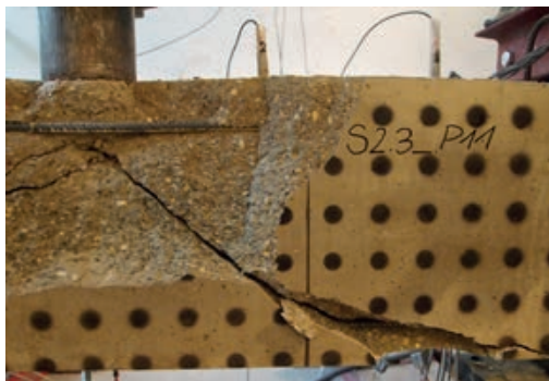
Stanzkegeldetail eines Balkenversuchs ohne Bügelbewehrung, geprüft bei einem Ladedruck von 0,6 bar | Punching cone detail of a beam test without stirrup reinforcement tested at a loading pressure of 0.6 bar | Photo: Lena Leicht
