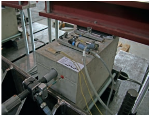
Balkenendversuch mit Spaltriss | Beam-End test with splitting crack | Photo: Marc Koschemann
