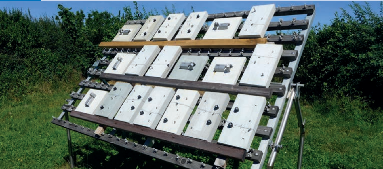
Lagerung der Carbonbetonprobekörper am Freibewitterungsstand des Instituts für Korrosionsschutz Dresden | Storage of the carbon concrete specimens at the outdoor weathering stand of the Institute for Corrosion Protection Dresden | Photo: Jürgen Triebert
