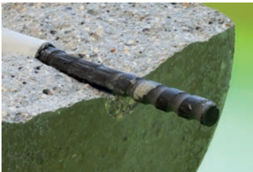
Zerstörter Carbonstab nach dem Verbundversuch | Destroyed carbon rod after the composite test | Photo: Sven Hofmann
