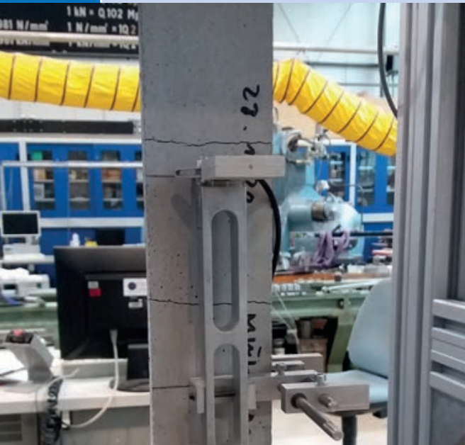
Dehnkörperversuche (links) und Kurzzeitauszugsversuche zur Qualitätssicherung (rechts) | Tensile tests (left) and short-term pull-out tests for quality control (right) | Photos: Zuhair Amer
