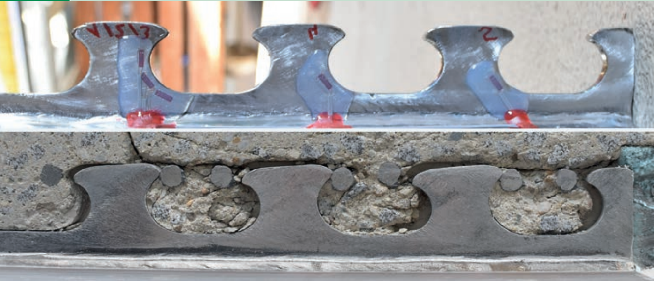
DMS-Applikation und Rissbild an einem Abscherversuch in Dübel-Längsrichtung | Arrangement of strain gauges and crack pattern after a push-out test in longitudinal direction | Photo: Cécilia Karge
