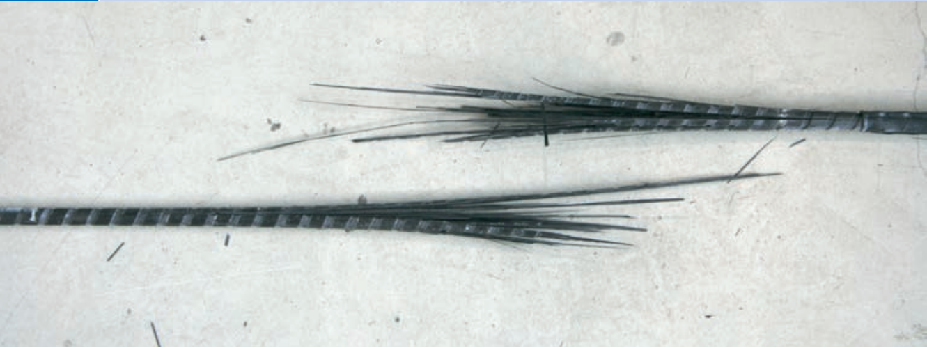
Zugversagen eines Probekörpers | Tensile failure of a specimen | Photo: Ronghua Xu
