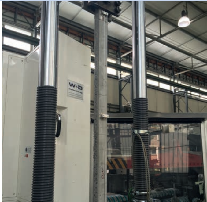
Statischer Versuchsaufbau mit Dehnkörper | Static test set-up with a tension-strain test element | Photo: Enrico Baumgärtel
