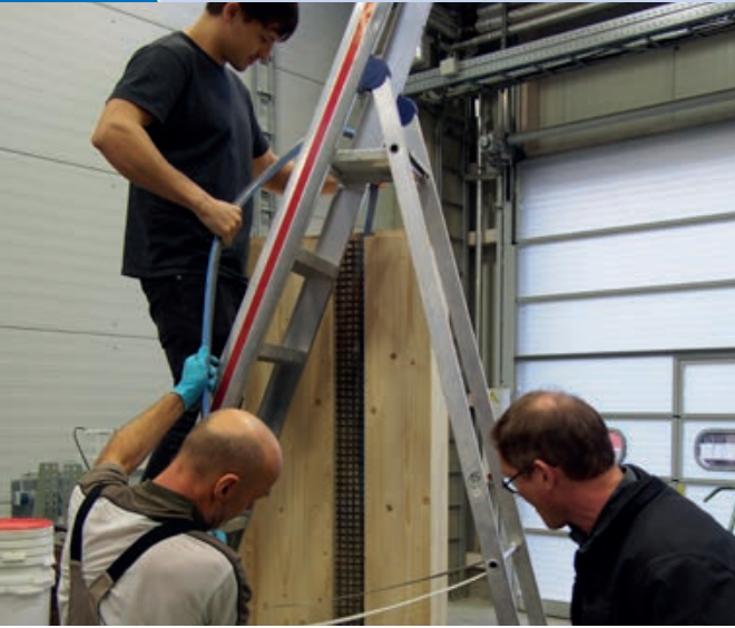
Herstellungstechnologie bei innenliegender Betonnut zur Verbindung zweier Brettsperrholzwandelemente (zur Beobachtung durch Plexiglas-scheibe) | Production technology with internal concrete groove for connecting two cross laminated timber wall elements (for observation through Plexiglas pane) | Photo: Kristina Farwig
