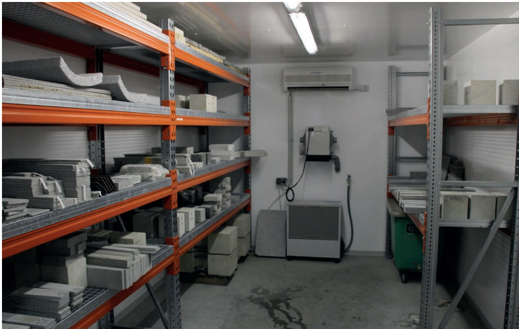
Klimakammer zur Lagerung der Proben bis zur Prüfung | Climatic chamber to storage specimens until testing | Photo: Ulrich van Stipriaan
