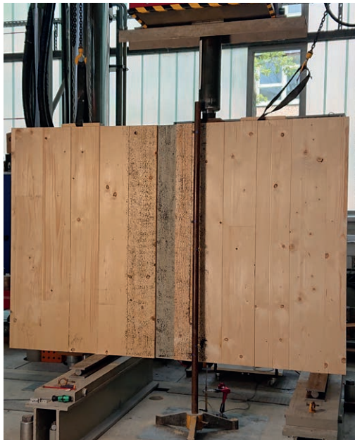
Prüfung Großbauteil ohne Holzflanken mit Verbindung aus Beton | Testing large component without wooden flanks with a concrete connection | Photo: Marén Kupke, AIB GmbH
