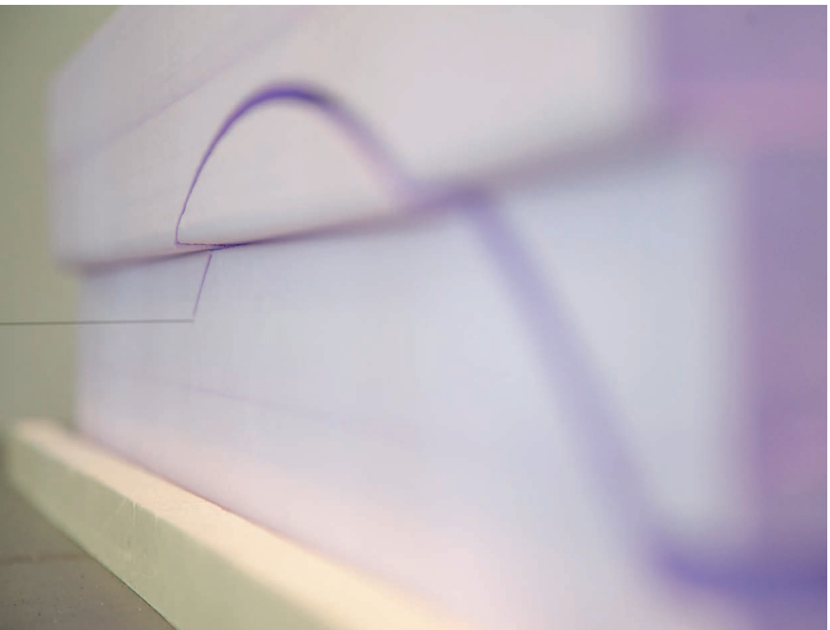
Herstellung eines Schalungselementes aus Styropor | Manufacturing of a formwork element made of Styrofoam | Photo: Stefan Gröschel
