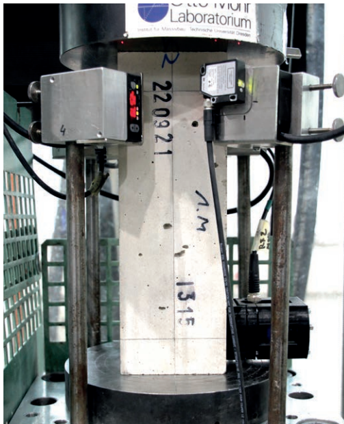
Probekörper unter Druckschwellenbeanspruchung | Concrete specimen under cyclic loading | Photo: Doreen Sonntag
