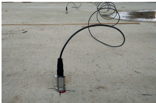
Schwingungsaufnehmer über dem Binder | Vibration transducer above the truss | Photo: Franz Bracklow
