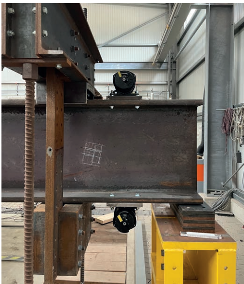
Zwei Unwuchtmotoren zur vertikalen Lasterzeugung am Demonstrator II | Two imbalanced rotors to generate vertical forces to Demonstrator II | Photo: Clara Schramm
