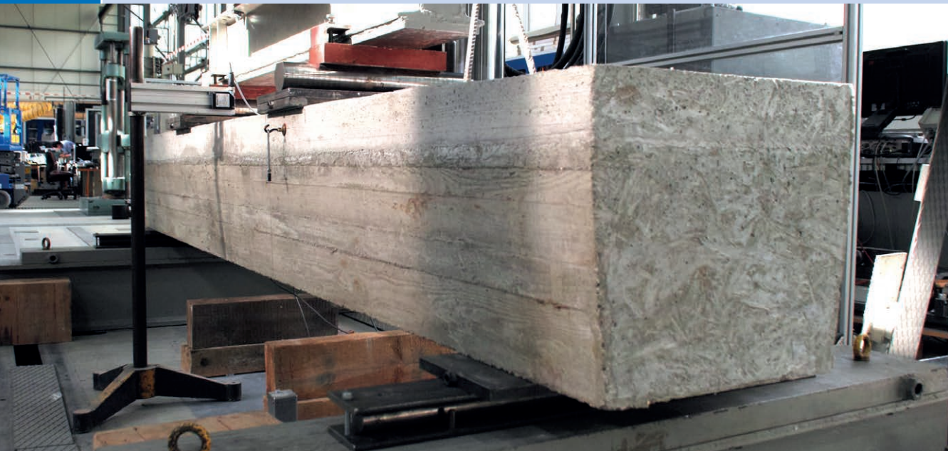
Prüfkörper im Maßstab 1 : 1 vor Versuchsdurchführung | Bending test of a beam in scale 1 : 1 | Photo: Oliver Steinbock
