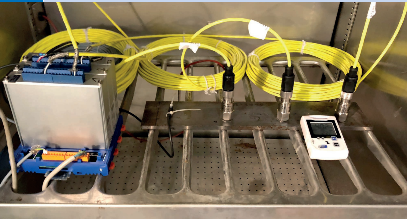
Vorversuche mit Beschleunigungsaufnehmern im Klimaschrank | Preliminary tests with different acceleration sensors in the climate chamber | Photo: Jan-Hauke Bartels
