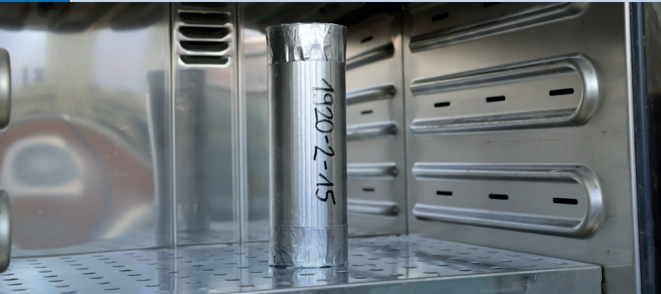
Versiegelter HPC-Zylinder während der Erwärmung für statischen Druckversuch | Sealed HPC cylinder during heating for static compression test | Photo: Martin Markert (University Stuttgart)
