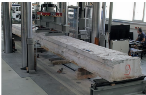
Brückenträger im Test | Bridge girder under pressure | Photo: Oliver Steinbock
