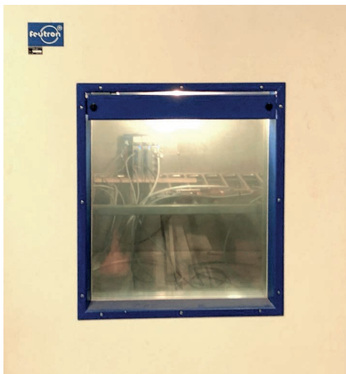
Vorversuche mit DMS im Klimaschrank | Preliminary tests with strain gages in the climate chamber | Photo: Jan-Hauke Bartels
