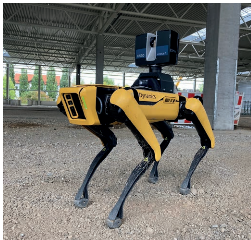
Autonomer Roboterhund mit zwei Hochleistungsrechnern und zahlreichen Sensoren auf einer GOLDBECK-Baustelle | Foto: Maximilian Schütz
