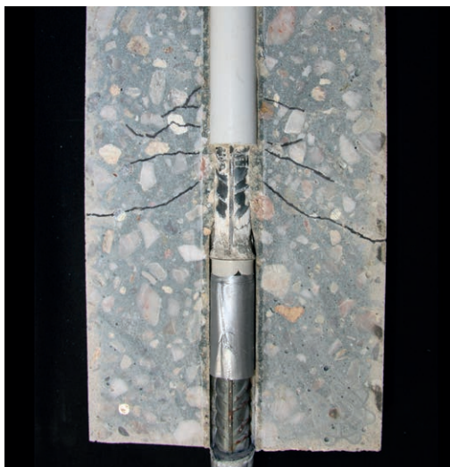
Rissbildung in der Verbundzone | Crack pattern around the bond zone | Photo: Marc Koschemann
