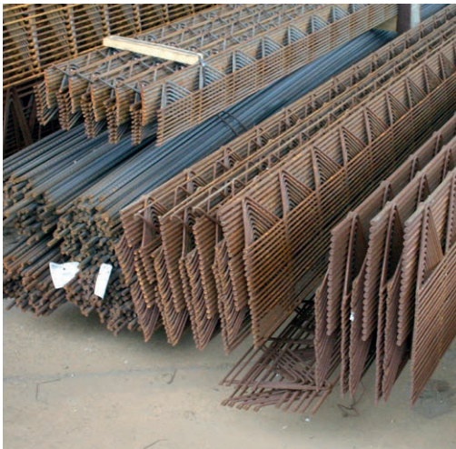
Gitterträger aus Stahl | Steel lattice girders | Photo: Harald Michler
