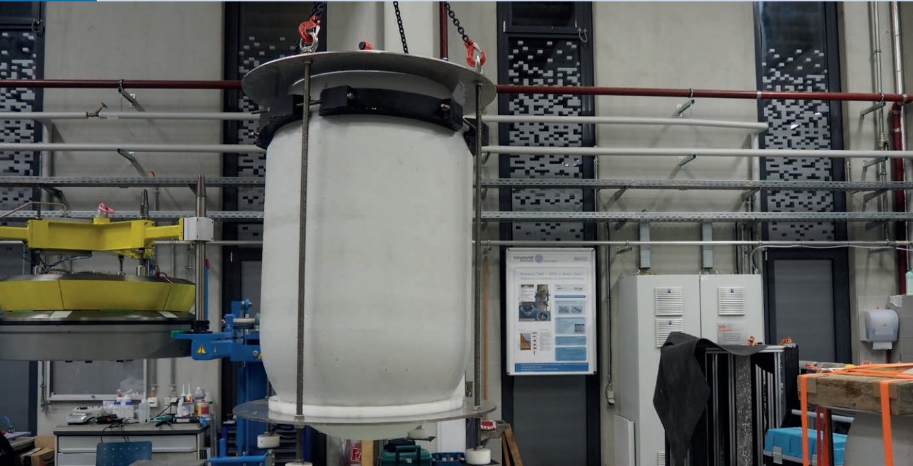
Betondruckgehäuse am Haken, bereit zur Prüfung | Concrete pressure vessel on hook, ready for testing | Photo: Martin Findeisen
