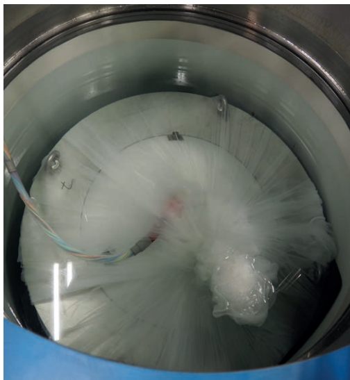
Betondruckgehäuse im Drucktank der Universität Rostock | Concrete pressure vessel in the pressure tank of the University of Rostock | Photo: Martin Findeisen
