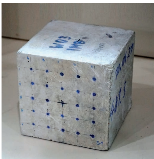
Würfelprobe mit Schlagmuster | Cube specimen with test pattern | Photo: Daniel Gebauer
