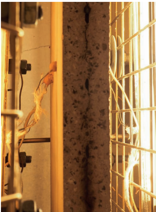
Aufspalten in der Gelegeebene während des Erwärmens | Splitting in plane of the reinforcement due to temperature | Photo: Karoline Holz
