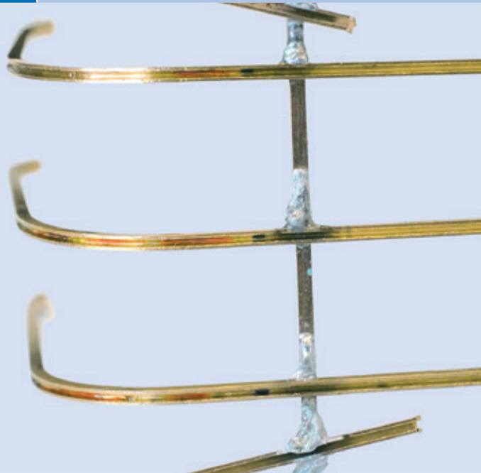
Faseroptische Sensoren, eingebettet in einem Trägergerüst aus Messing-U-Profilen; die Lage der Messstellen ist durch die rot und blau eingefärbten Bereiche gekennzeichnet | Fibre optic sensors embedded in a support frame made of brass U-profiles; the location of the measuring points is indicated by the red and blue coloured areas | Photo: Sven Hofmann
