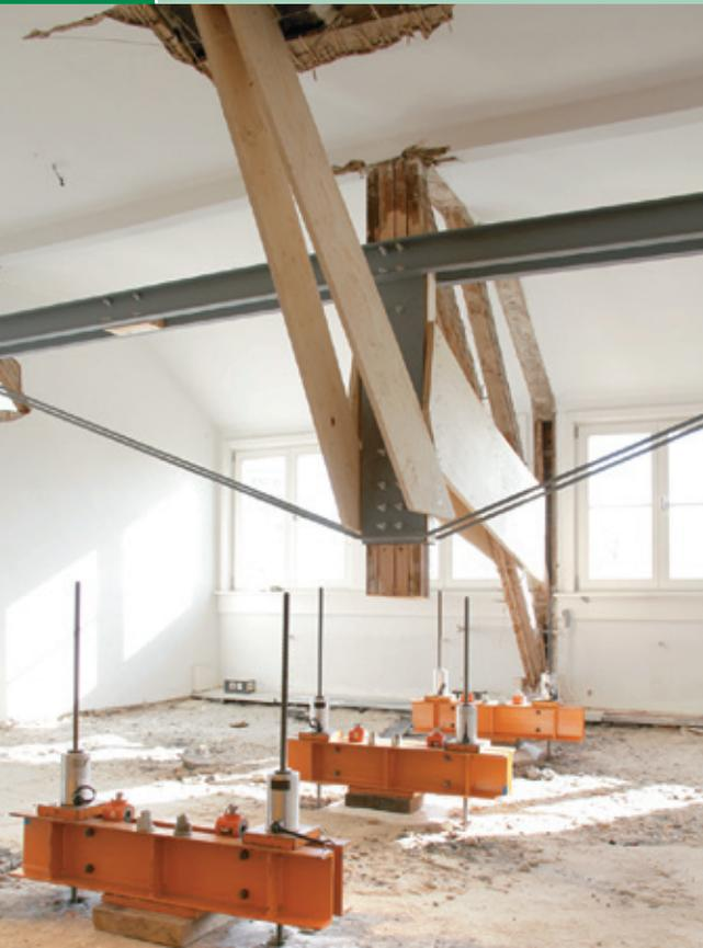
Belastungseinrichtung zur Prüfung eines Unterzugs
