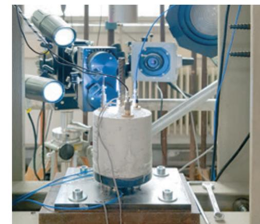
Probekörper vor dem Versuch im Fallturm
