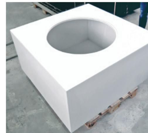
Prototyp eines Pontons aus Carbonbeton | Prototype of a carbon reinforced concrete pontoon | Photo: Egbert Müller
