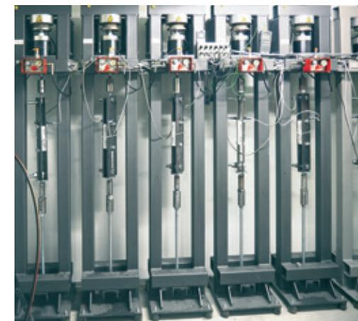
Vorversuche zum Dauerverbund | Preliminary long-term bond tests
