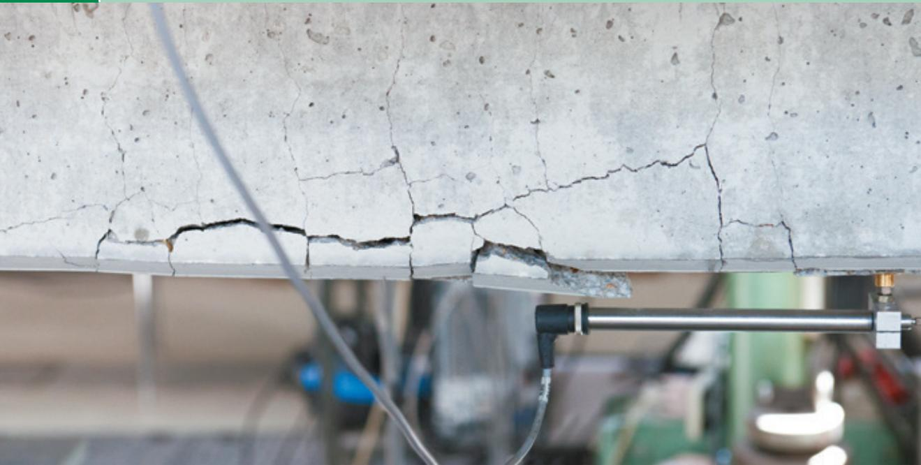
Test einer carbonbewehrten Pi-Platte | Test of carbon reinforced Pi slab | Photo: Sven Hofmann
