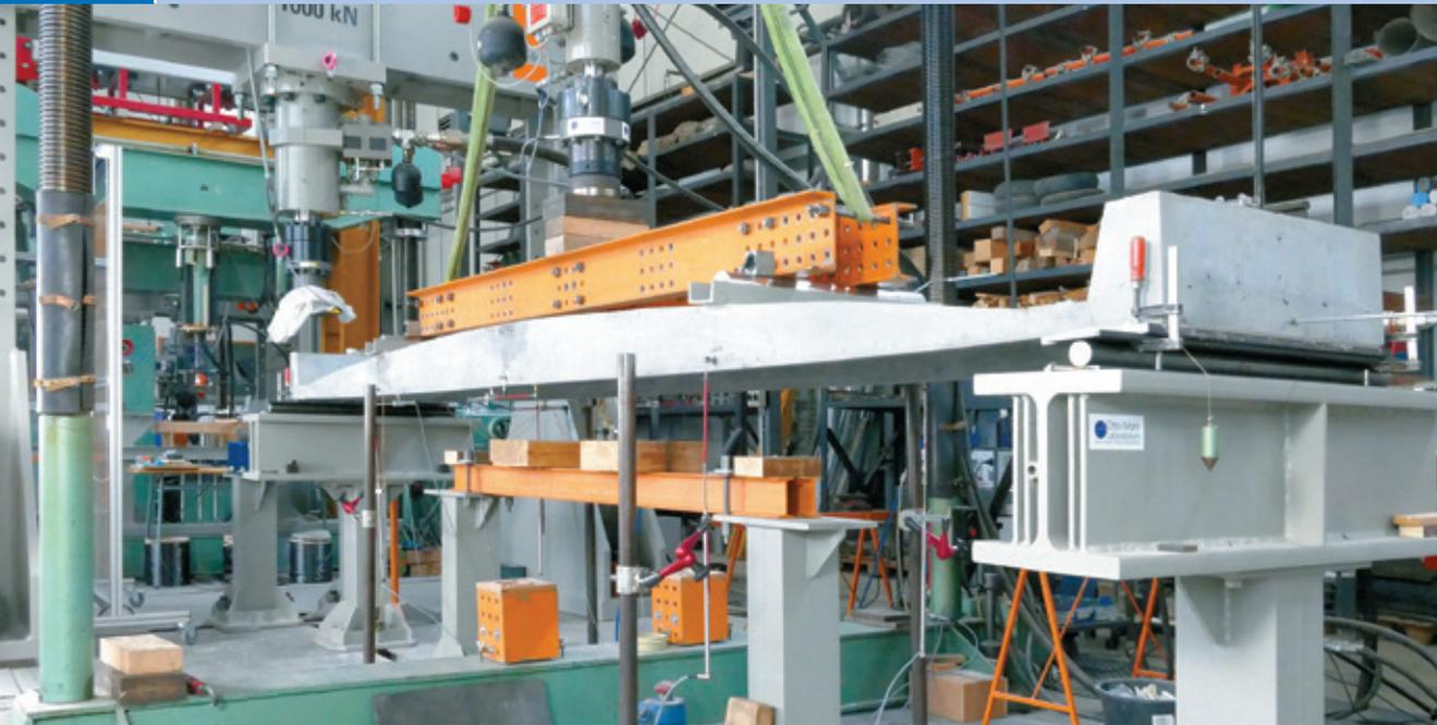
Deckenelement im Prüfstand des Otto-Mohr-Laboratoriums | Test stand at Otto Mohr Laboratory with an optimized ceiling element
