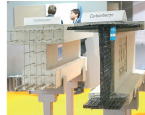
Der Vergleich der Doppel-T-Träger zwischen Stahl- und Carbonbeton auf der Messe BAU 2017 | The comparison of double T beams made of steel and carbon reinforced concrete at the BAU 2017 trade fair Photo: Sandra Kranich
