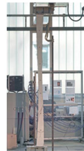
Stützenverformung unter exzentrischer Lasteinleitung
