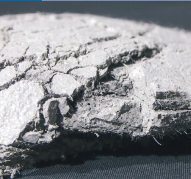
Bruchstück eines Probekörpers, der aus Beton mit Stahl- und PP-Fasern hergestellt wurde, nach Impactbelastung in der beschleunigten Fallanlage | Fragments of a specimen made of fibre reinforced concrete (PP fibres and short steel fibres) after impact testing at the accelerated drop tower facility | Photo: Marcus Hering
