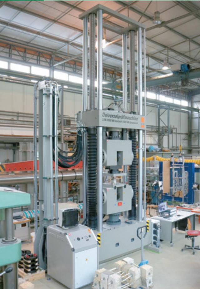
Die neue 2500-kN-Universalprüfmaschine | The new 2500 kN universal testing machine
