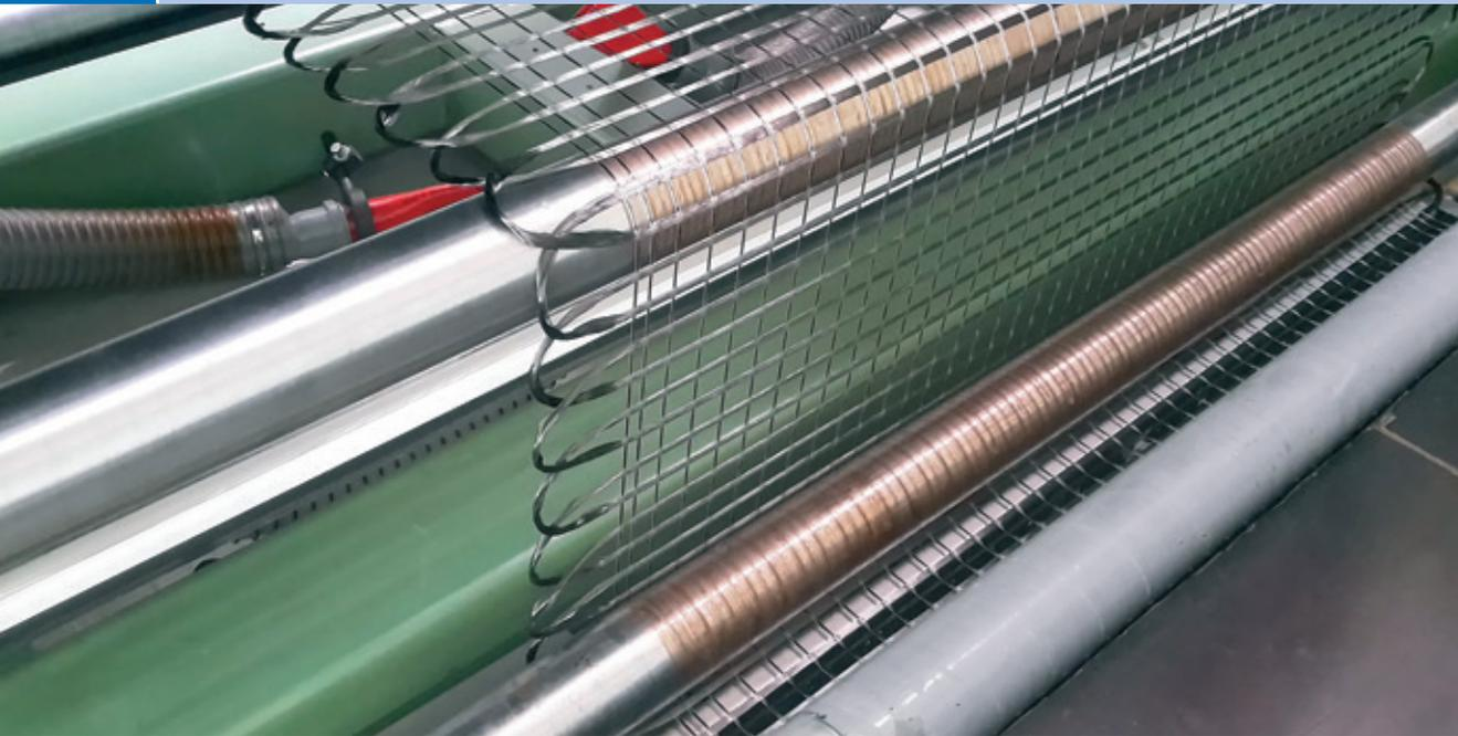
Maschinelle Herstellung der Schlaufen in Schussrichtung | Mechanical production of the loops in the weft direction | Photo: Kerstin Speck
