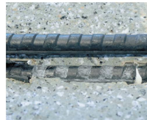
Mögliches Versagen von Carbonstäben in Beton, hier war das Abscheren der Kunststoffprofilierung maßgebend. Possible failure mode of rebars made of carbon fibres, here failure of the lugs of the rebar | Photo: Alexander Schumann
