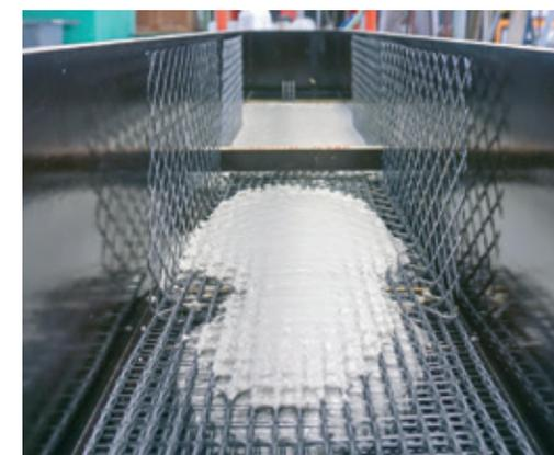
Betonage eines textilbewehrten Balkens mit neu entwickelter Feinbetonrezeptur für kleinteilige Versuche für die ZiE | Concreting of a carbon reinforced beam with a newly developed concrete mixture for small-scale approval tests | Photo: Robert Schneider
