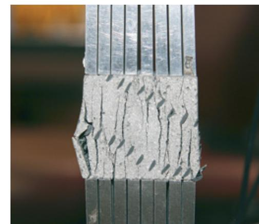
Bruchbild eines schräg bewehrten Textilbetonwürfels
