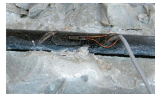
Applizierte Dehnmessstreifen | Strain gauge applied on a prestressing steel | Photos: Heiko Wachtel
