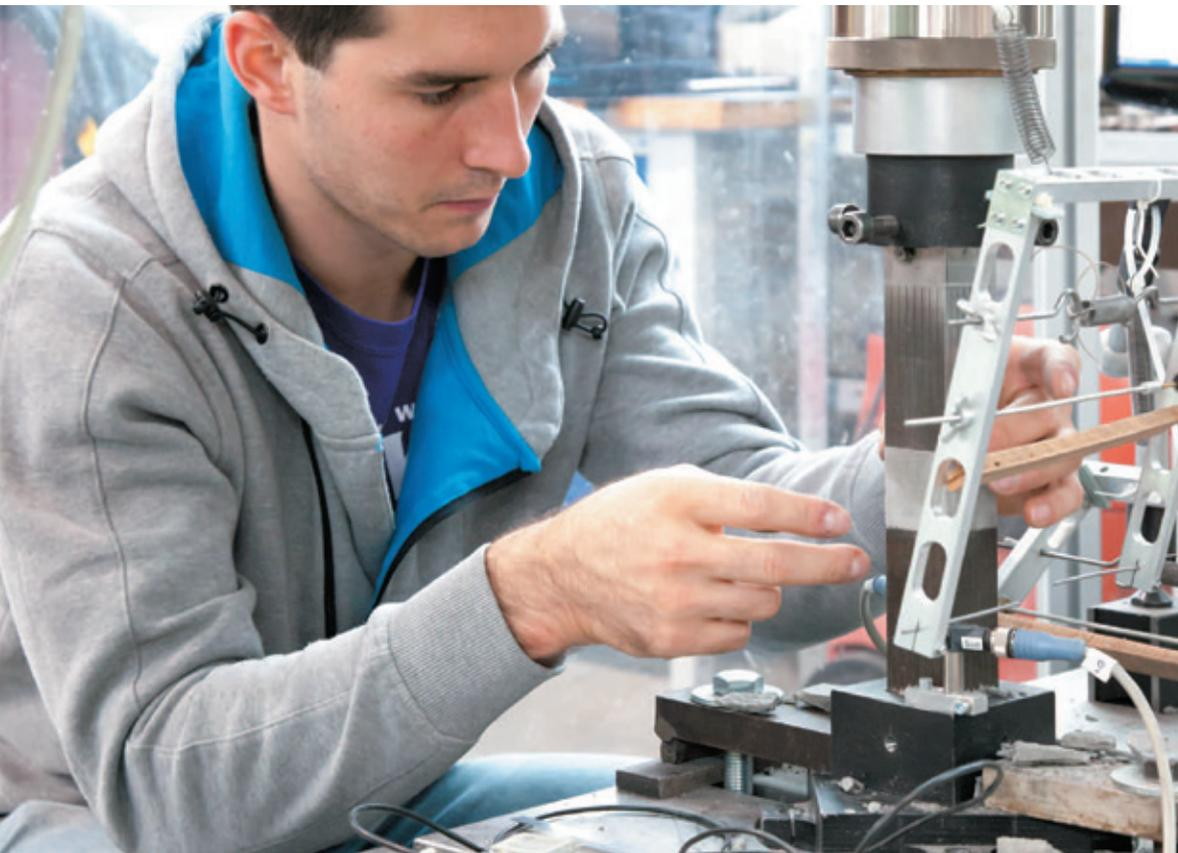
Einrichtung eines Versuchs zur Druckuntersuchung von Carbonbeton | Preparing a compression test on a carbon reinforced concrete cube
