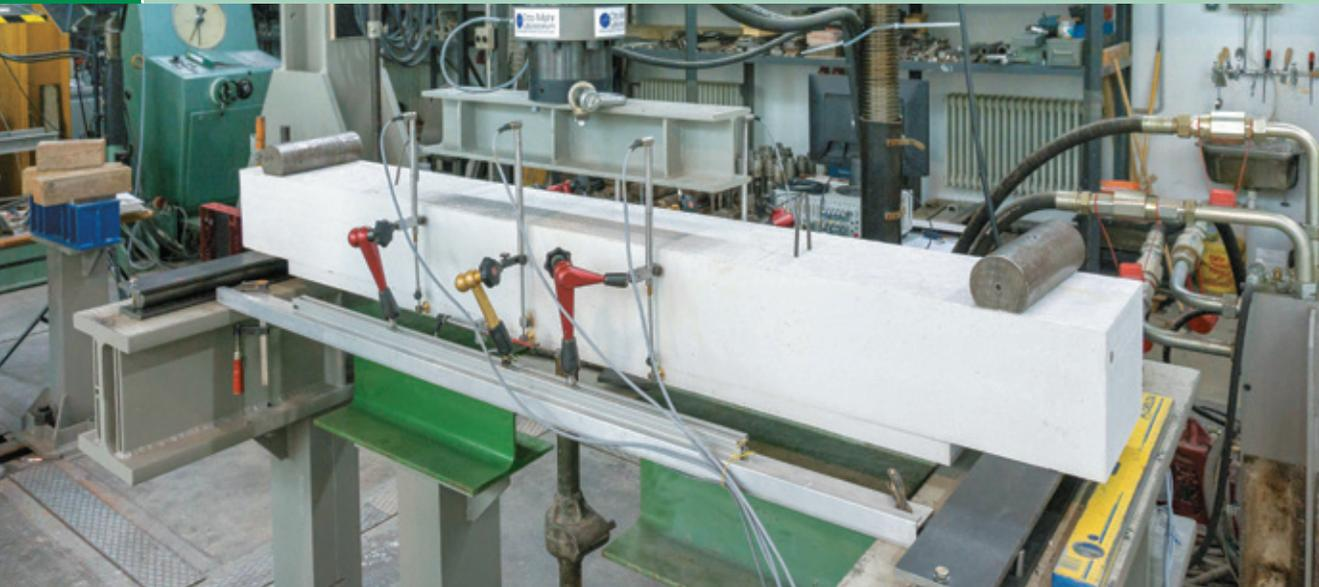
Versuchsaufbau zur Ermittlung der Schubtragfähigkeit einer mit Carbondtextil bewehrten Fuge | Test setup to determine the shear strength of a carbon fibre reinforced joint | Photo: Robert Schneider
