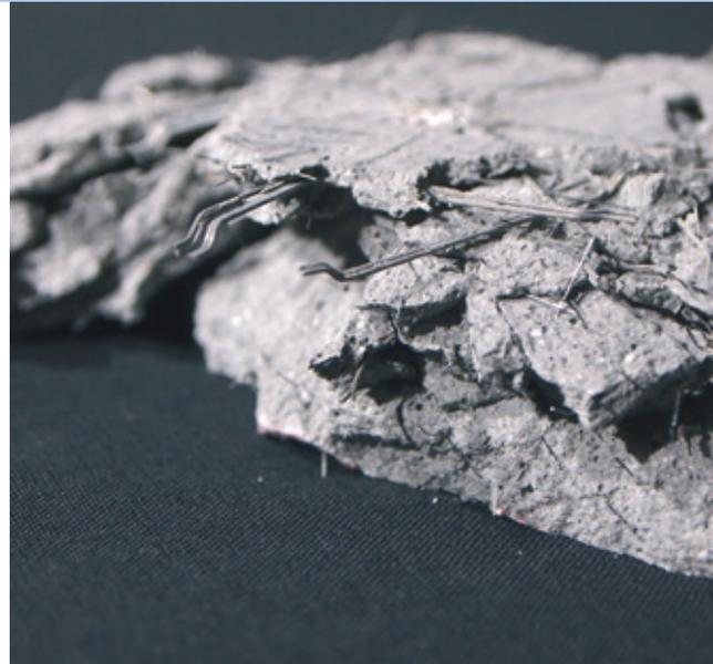
Bruchstück eines Probekörpers, der aus Beton mit Kurzstahlfasern (an den Enden gerade bzw. mit Haken) hergestellt wurde, nach Impactbelastung in der beschleunigten Fallanlage | Fragments of a specimen made of fibre reinforced concrete (short straight and hooked steel fibres) after impact testing at the accelerated drop tower facility | Photo: Marcus Hering
