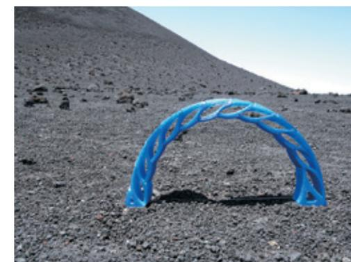
3D-Druck einer selbstaufrichtenden Konstruktion aus modularen Elementen für den Einsatz auf dem Mond, fotografiert während der Demo-Mission im Sommer 2017 auf dem Ätna
