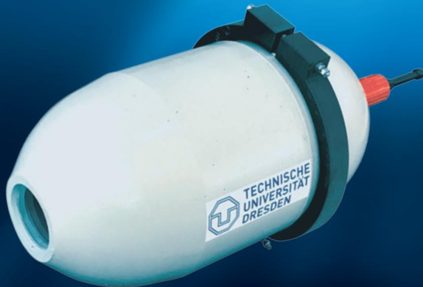
Betondruckgehäuse mit verklebter Saphirglasscheibe | Concrete pressure housing with a bonded sapphire glass layer
