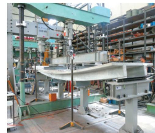
4-Punkt-Biegetest einer Pi-Platte aus Carbonbeton
