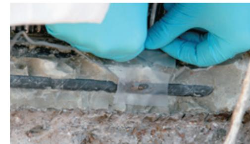
Applizieren der Dehnmessstreifen | Application of strain gauges
