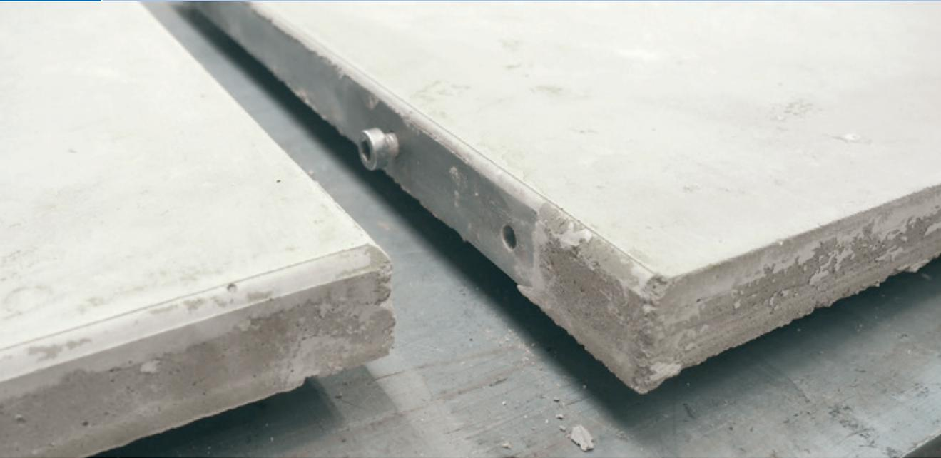
Einbauteil zur Längsverbinding von dünnen Carbonbetonelementen | Built-in part for the longitudinal connection of thin elements out of carbon reinforced concrete | Photo: Juliane Wagner
