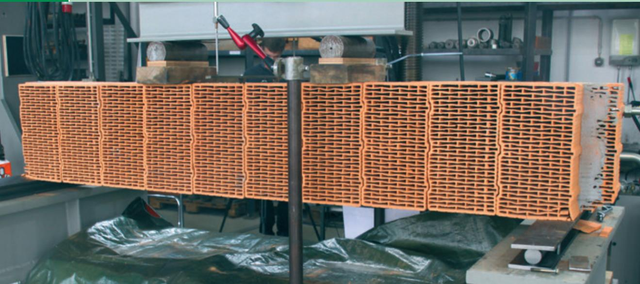
4-Punkt-Biegeversuch an textilbewehrtem Mauerwerk | 4-point bending test on textile reinforced masonry | Photo: Maik Erler
