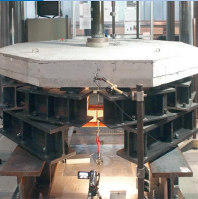
Prüfaufbau für Durchstanzuntersuchungen geschichteter Deckenplatten | Experimental setup to study punching shear failure of layered ceiling slabs | Photo: Kristina Farwig
