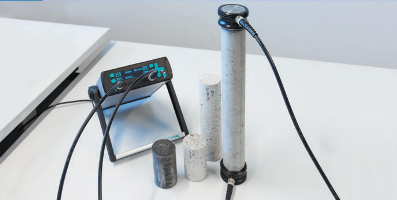
Messung der Wellenlaufzeit mittels Ultraschall | Measuring of the wave transit time with ultrasonic | Photo: Sven Hofmann
