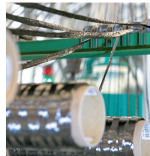
Herstellung von Carbontextilien; hier: in Textilmaschine eingelegte Carbonspulen | Manufacturing of carbon textiles; here: carbon fibre tubes installed in a textile machine | Photo: Thilo Schoch
