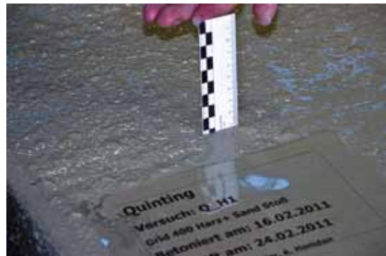
Kontrolle der Einbaulage des Textils
