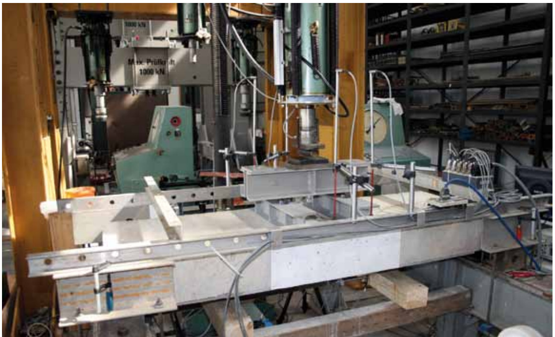
Versuchsstand für Biegeversuche an verstärkten Stahlbetonplatten Test set up for bending tests of the strengthened concrete slabs
