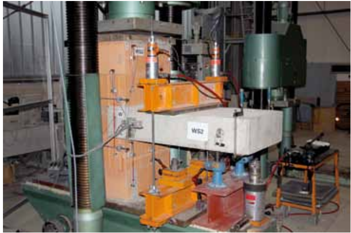
Versuche an geschlitzten Mauerwerksprüfkörpern
