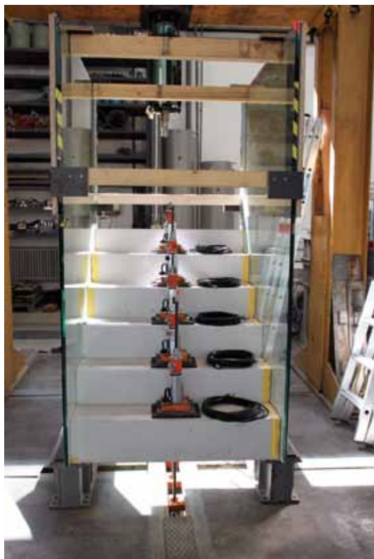
UHPC-Treppe im Belastungsversuch
