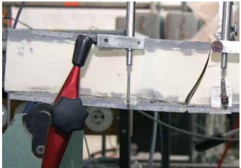
Versuchskörper mit Rissbildung im 3-Punkt-Biegeversuch Specimen in a 3-point bending test and crack formation
