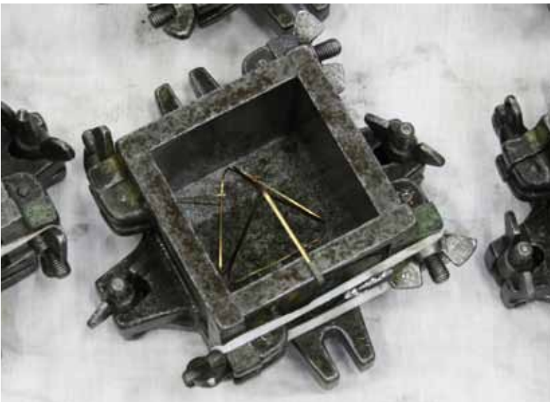
Tetraederträgergerüst in einer Würfelform vor der Betonage Tetrahedron framework in cubic cast before concreting
