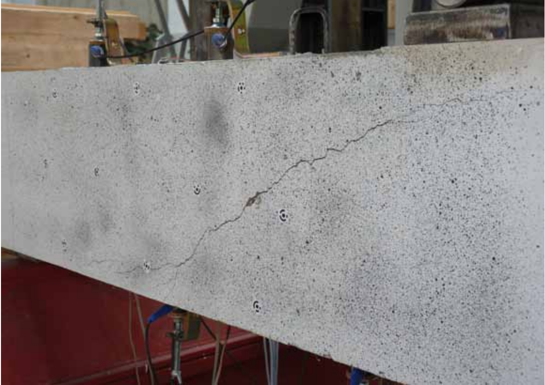
Schubversagen bei einem Stahlbetonbalken
