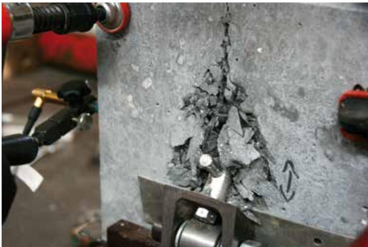
Auszugversuch einer Gewindehülse an kleinteiligen Probekörpern
