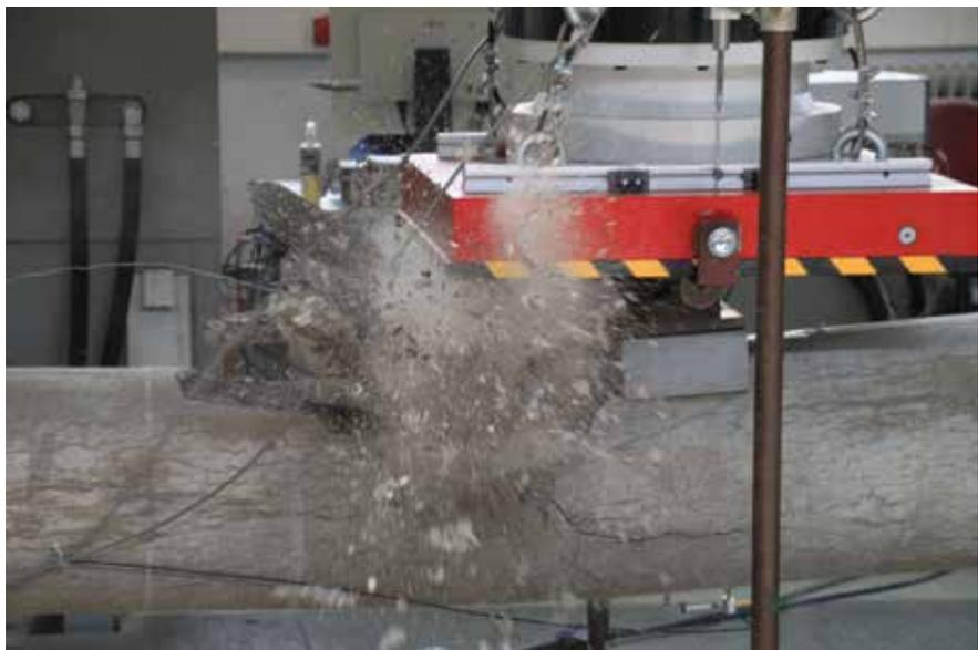
Prüfung eines Spannbetonmastes Foto: Sabine Wellner
