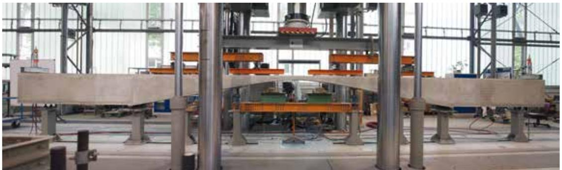
Großformatiger Träger im Versuchsstand
