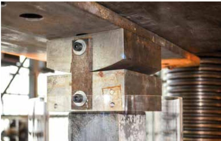
Realisierung der gelenkigen Linienlagerung im Versuch;
