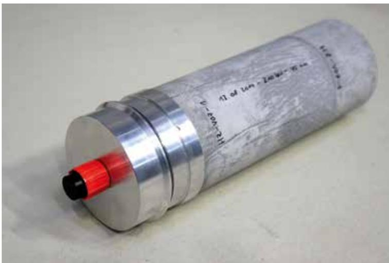
Prototyp eines Druckgehäuses aus UHPC für die Tiefsee
