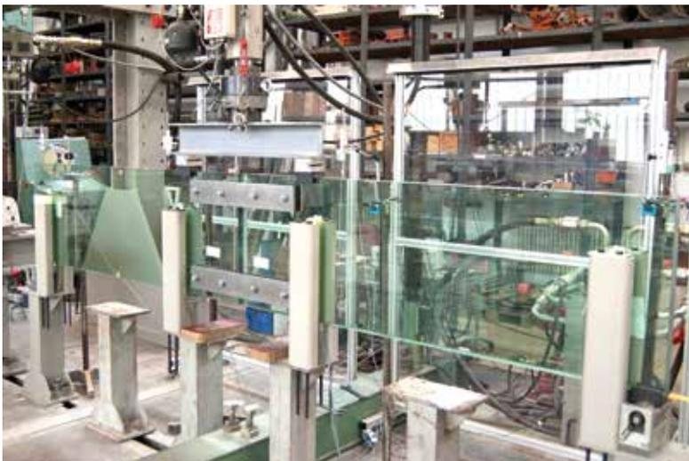
Versuchsaufbau Biegeversuch an Laschenstößen für Glasschwerter
