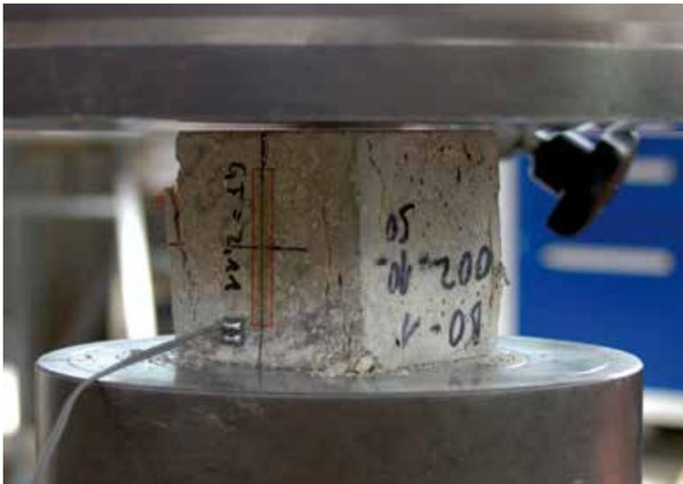
Beton versagt bei einem einaxialen statischen Druckversuch
