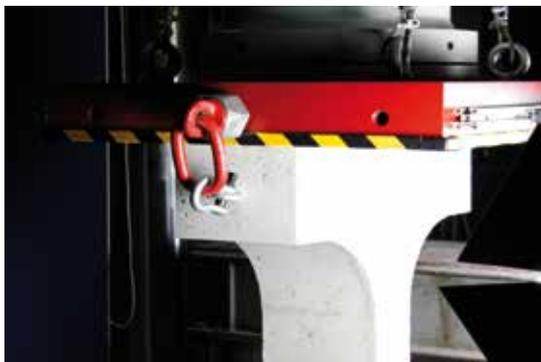
Prüfkörper mit Viertelkreisvoute im Test
