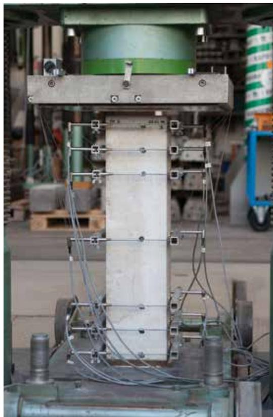
Untersuchung des Lasteinleitungsbereiches von Stützen Foto: Egbert Müller
