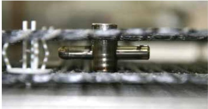
Fixierte Textilbewehrungen mit Gewindehülse für die Betonage im Gießverfahren
