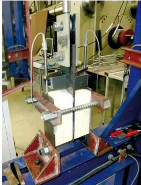
Schubversuch an Polyurethanschaumkernen
