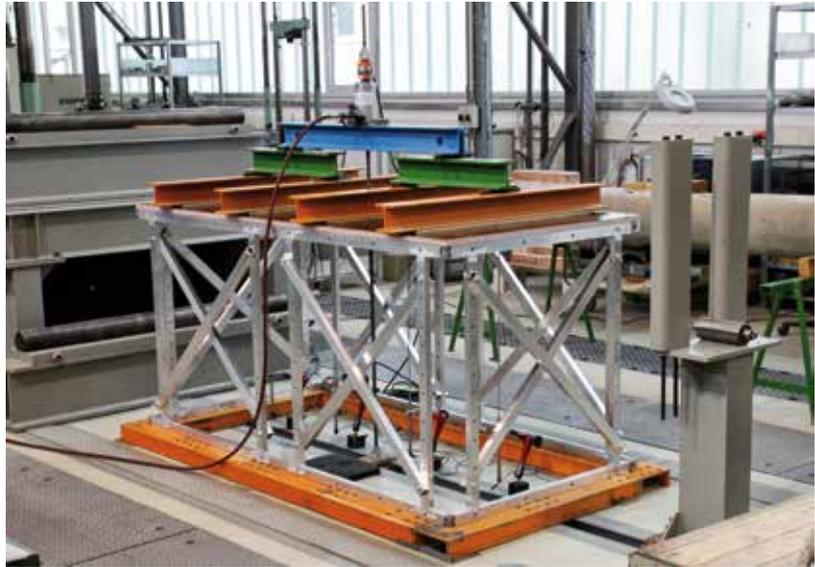
Beanspruchung der Leichtbauplatte im Vierpunkt-Biegeversuch
