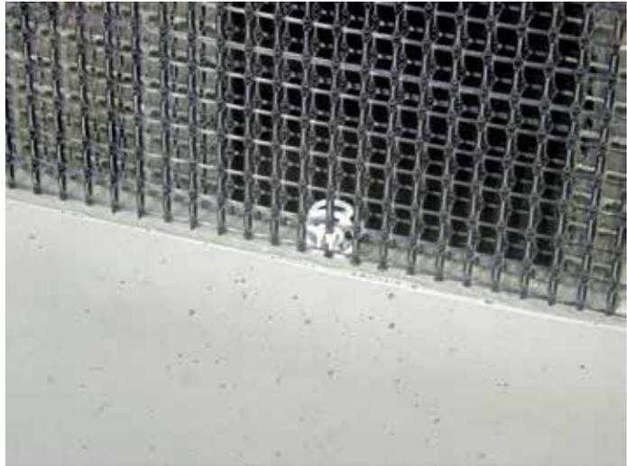
Betonage im Gießverfahren mit DistTEX
