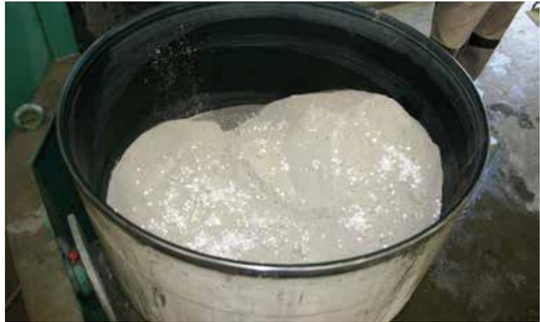
Feinbeton-Trockenmischung mit Polypropylen-Kurzfasern
