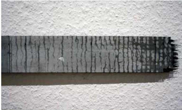
Textilbetonprobekörper nach dem Auszugversuch
