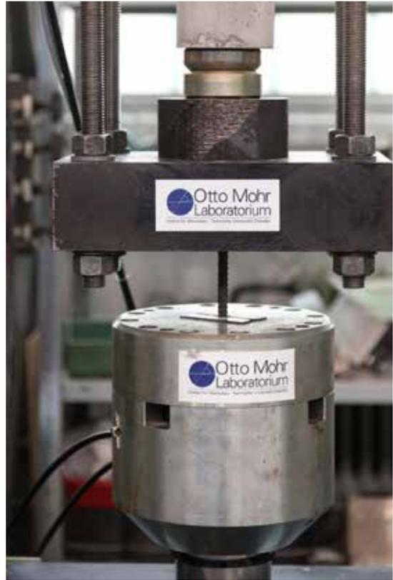
Versuchskonfiguration für quasi-statischen Pull-out-Test an kleinem Zylinder
