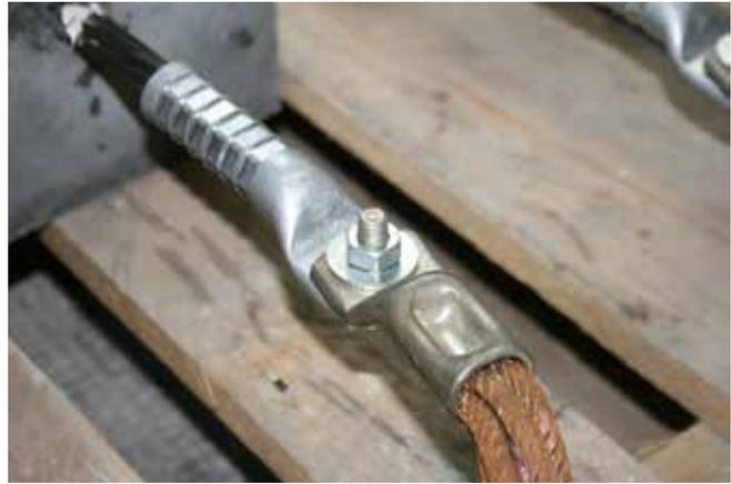
Litzen unter Spannung – Kontaktierung der Spannstähle zur thermischen Vorbelastung des Verbundbereichs
