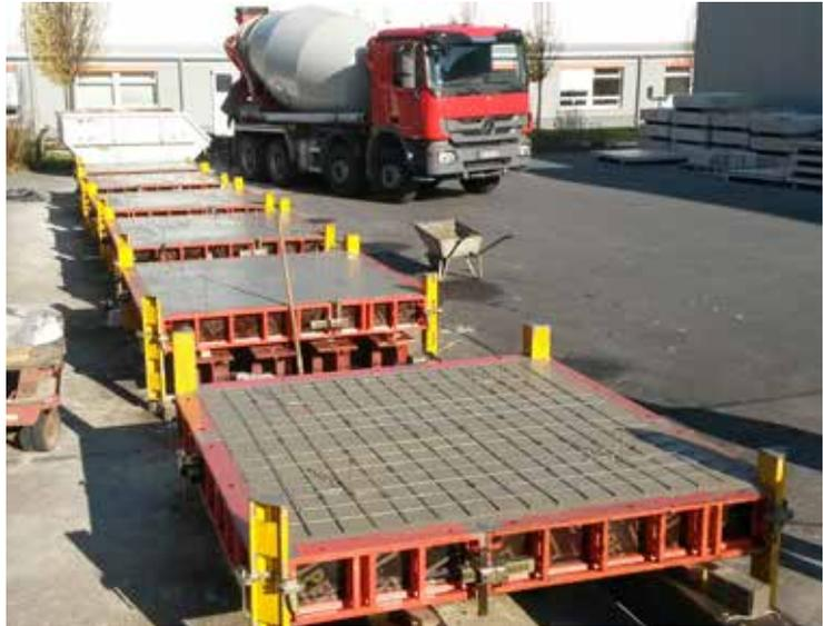
Die großformatigen geschichteten Platten werden auf der Freifläche des OML hergestellt.
