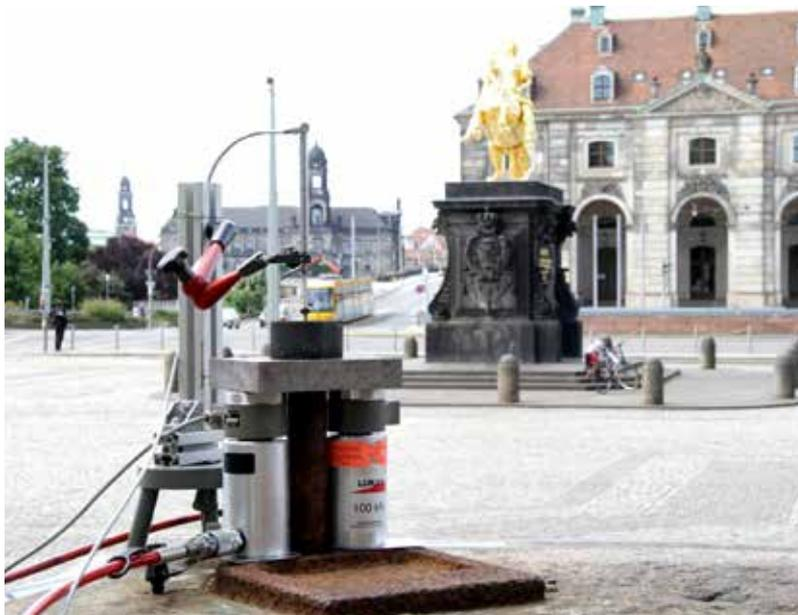
Belastungseinrichtung für die Ankerprüfung
