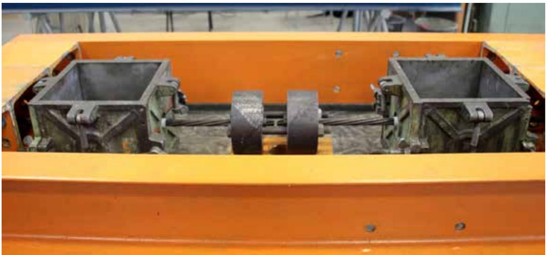
Litzen unter Spannung – Betonage der Auszugkörper mit vorgespannten Spannstählen
