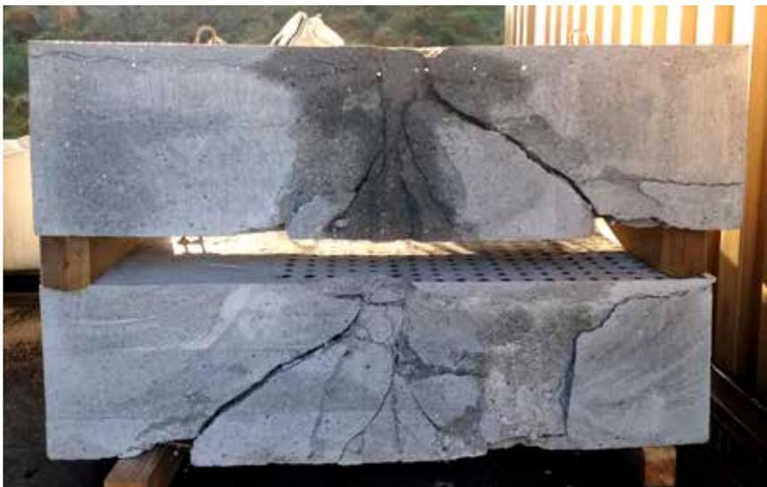
Durchstanzte Platte nach einem Fallturmversuch
