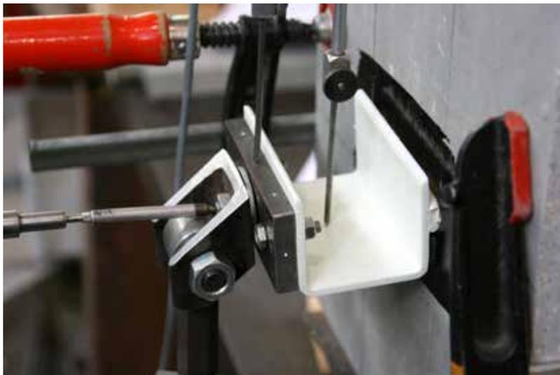
Prüfung der Klebeverbindung zwischen GFK-Profil und Textilbetonplatte
