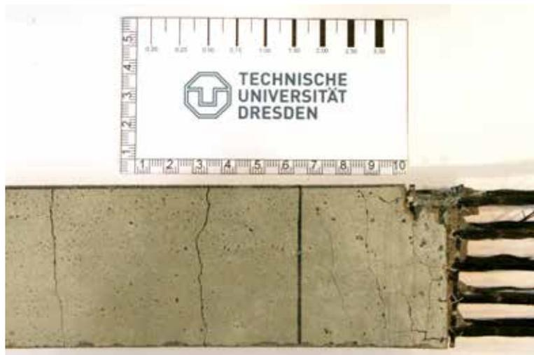
Rissabstände werden durch Rovingdurchmesser und -abstand beeinflusst
