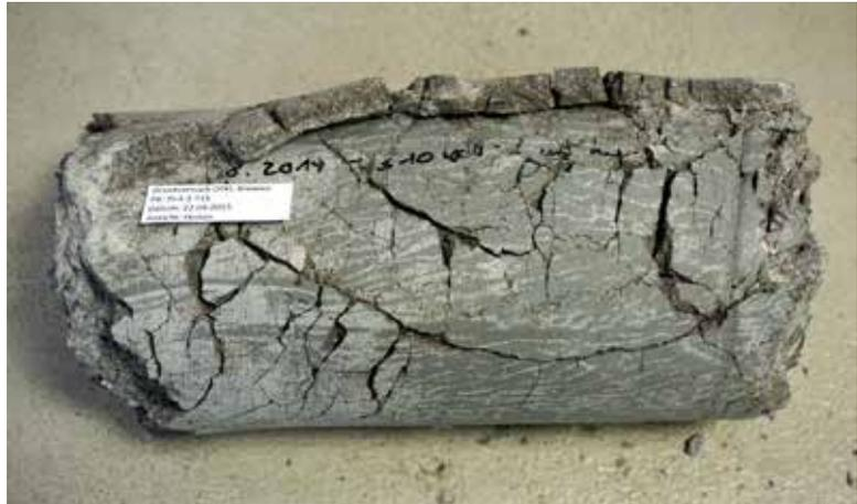
UHPC-Druckgehäuse nach der Implosion im Drucktank beim DFKI in Bremen
