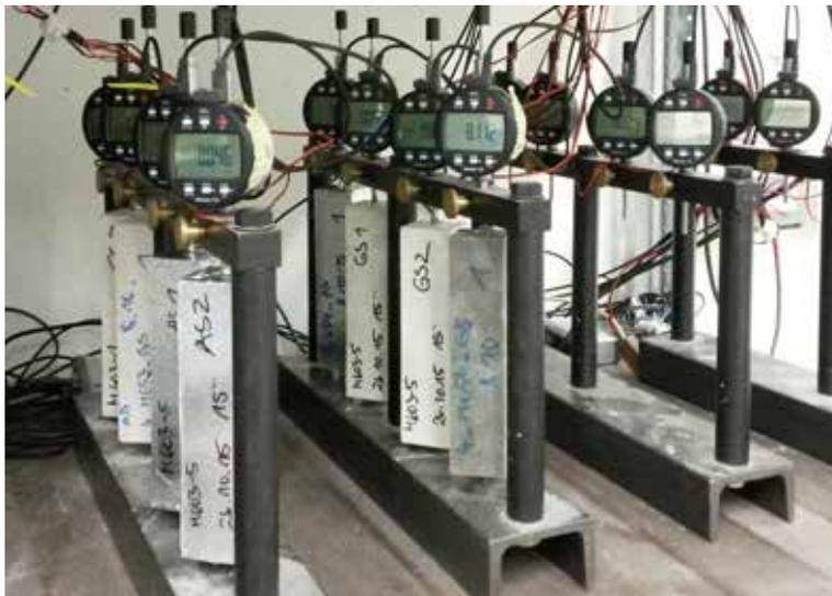
Schwinduntersuchungen an Normal- und Porenleichtbeton
