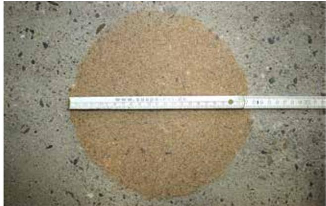
Anwendung des Sandflächenverfahrens zur Überprüfung der Rauigkeit des Untergrundes an einer Musterprobe bei einer Sanierungsmaßnahme
