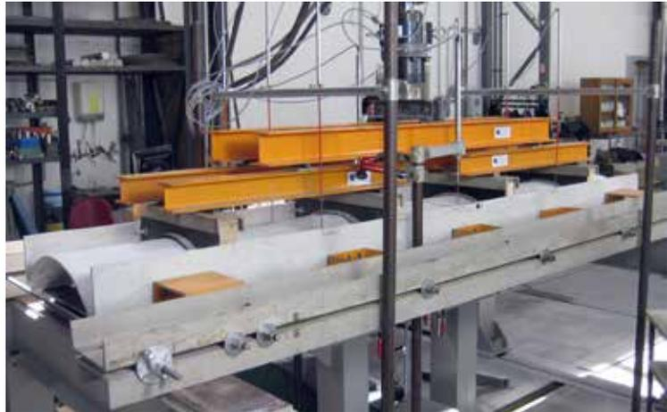
6-Punkt-Biegeversuch an einem NTRC-Deckenelement
