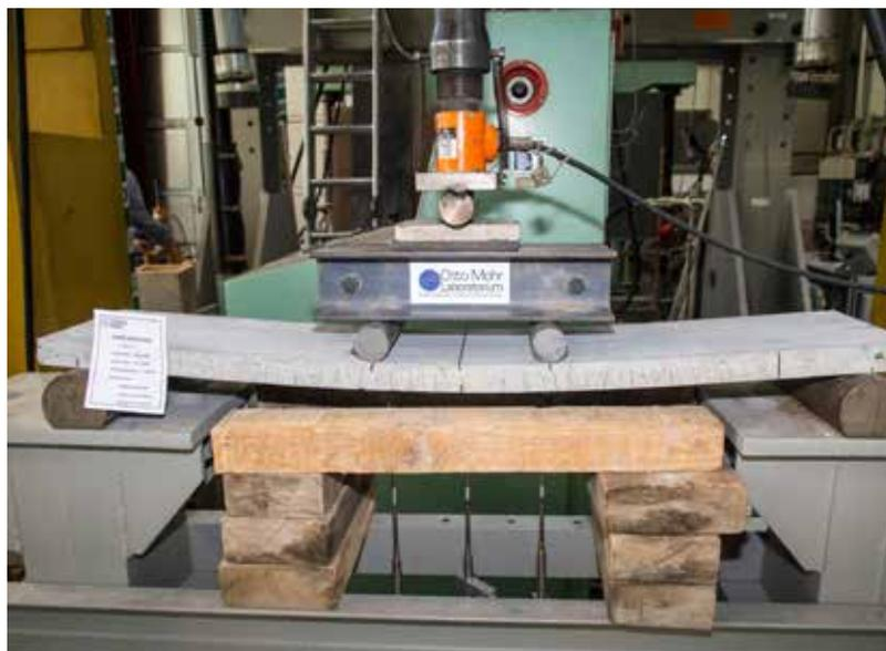
Mäßige Durchbiegung beim Biegeversuch an einem vorgespannten Balkenbrett
