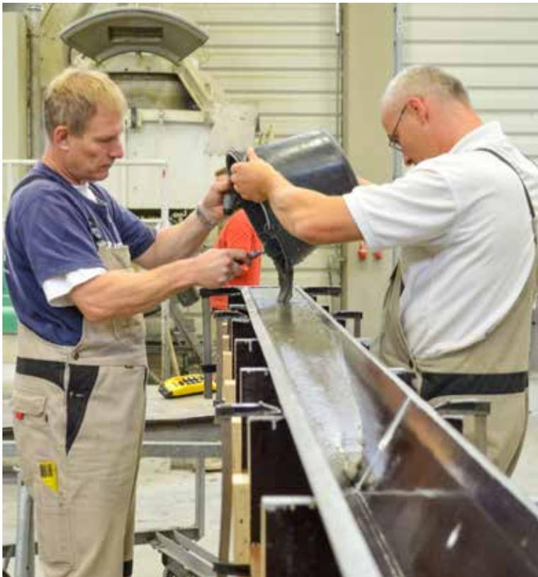
Schalung und Betonage einer Stütze mit dreieckigem Querschnitt
