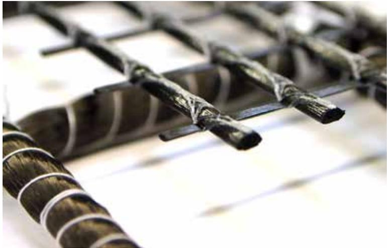
Übliche Carbonbewehrung (oben liegend) und prototypische Carbonbewehrung mit größerem Querschnitt (darunter)
