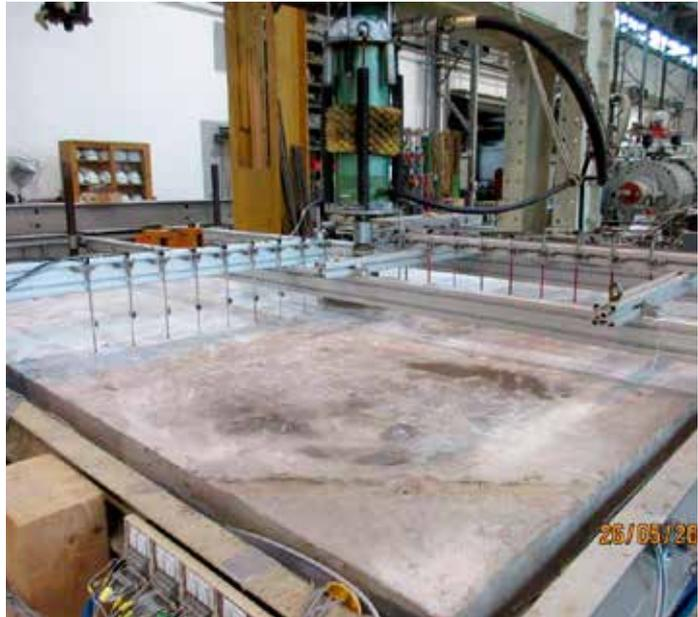
Versuchsstand mit hochduktilen Beton als Straßenbaumaterial
