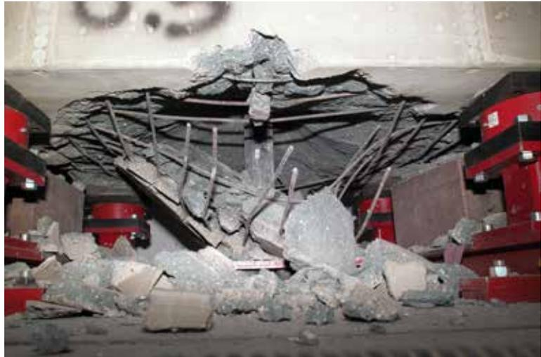
Stahlbetonplatte unmittelbar nach einem Impaktversuch
