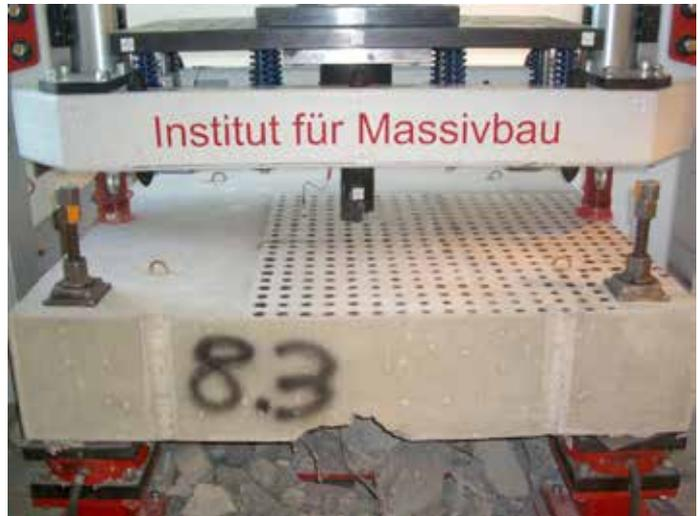
Stahlbetonplatte nach einer Impaktbelastung
