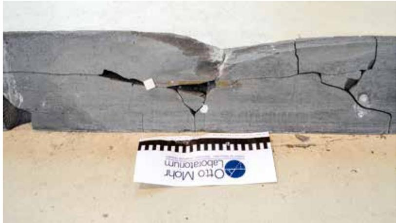
Bruchbild einer dreieckigen Stütze in Stützenmitte
