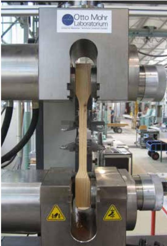
Kennwertermittlung an einem Holzzugstab
