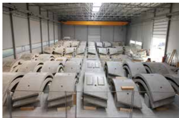
Bild 16: Tübings für den Tunnel des neuen Wasserkraftwerks in Pfunds/Österreich (Foto: Robert Zobel)
