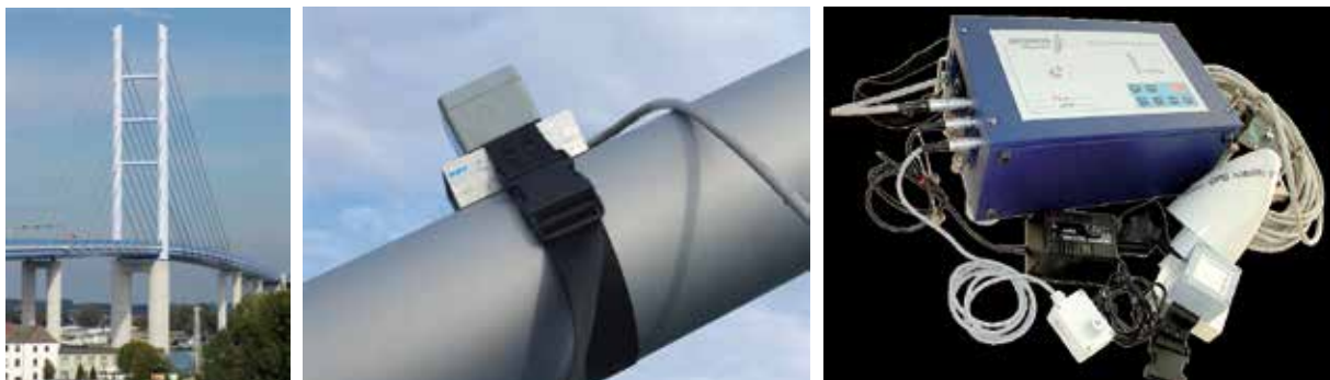
Bild 24: Messungen der Seilkräfte an der Strelasundbrücke mit dem BRIMOS® Recorder (Fotos: M. Buschlinger, BBV)
