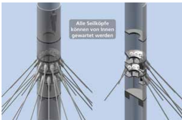
Bild 24: Seilbefestigung am Pylon und Inspektionsraum (© ipv Delft)
