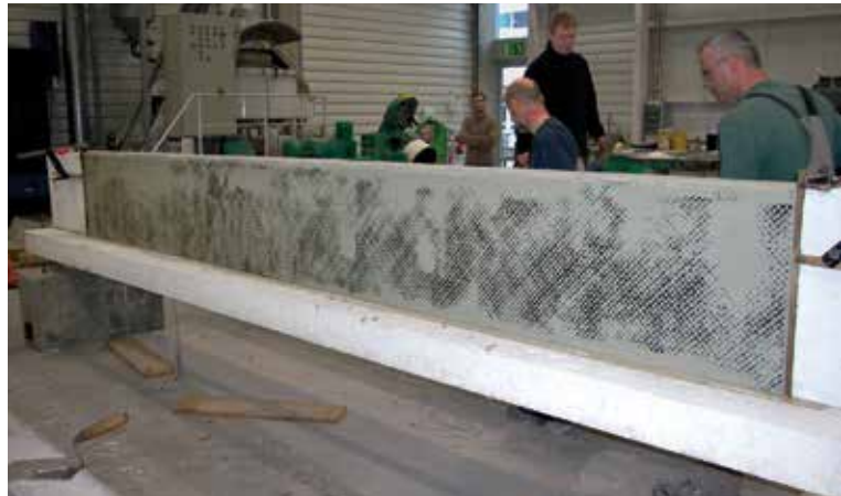
Bild 8: Verstärkung eines Plattenbalkens mit einem 45-°-Carbontextil für Querkraftversuche, hier für eine einfachere Ausführung im Labor auf dem Kopf liegend
