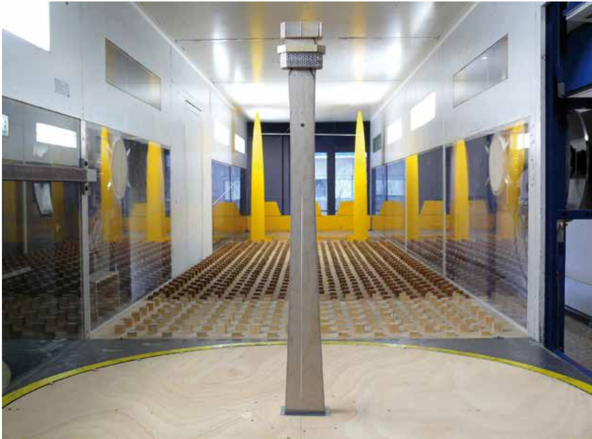
Bild 22: Pfeilermodell im Windkanal
