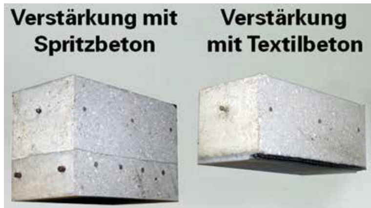
Bild 3: Verstärken im Vergleich Spritzbeton – Textilbeton (Grafik: Harald Michler)
