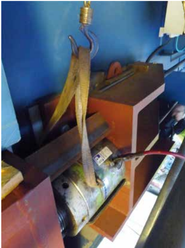
Bild 13: Vorspannkonstruktion mit Spann- und Festanker
