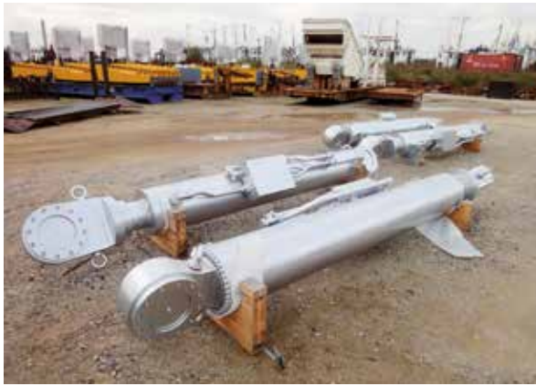
Bild 9: Hydraulikzylinder mit Drehlagern (Foto: Jan Lüdders)
