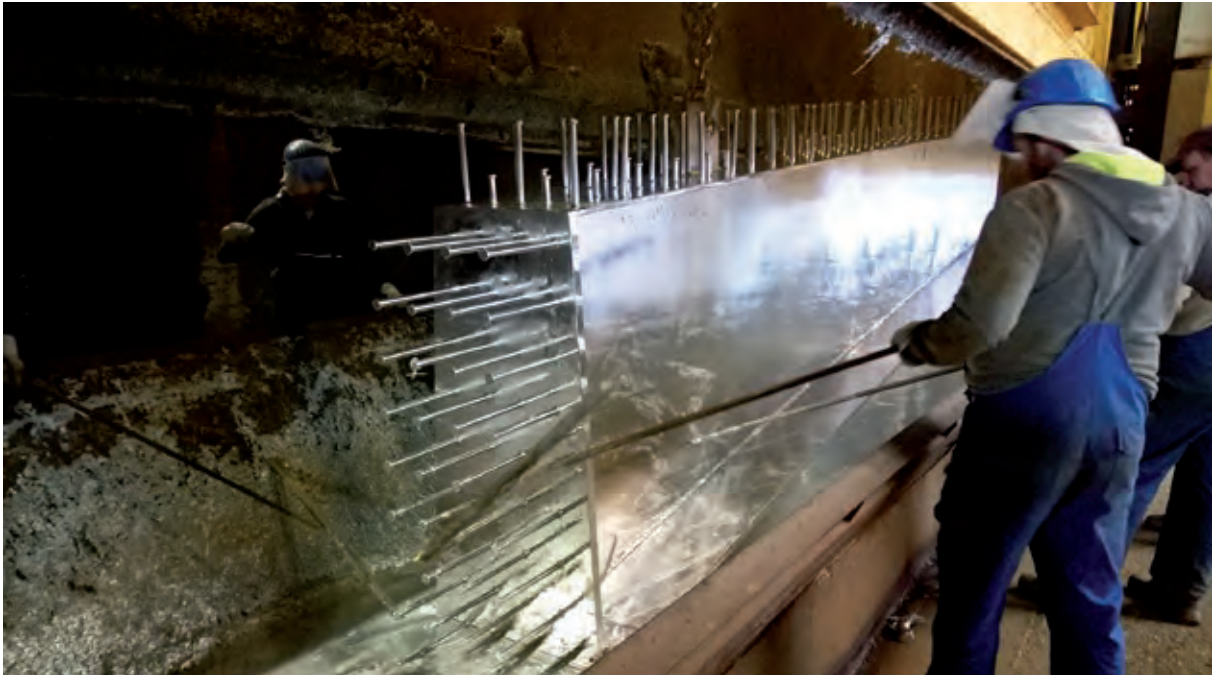
Bild 7 Tauchvorgang in der 450 °C heißen Zinkschmelze
