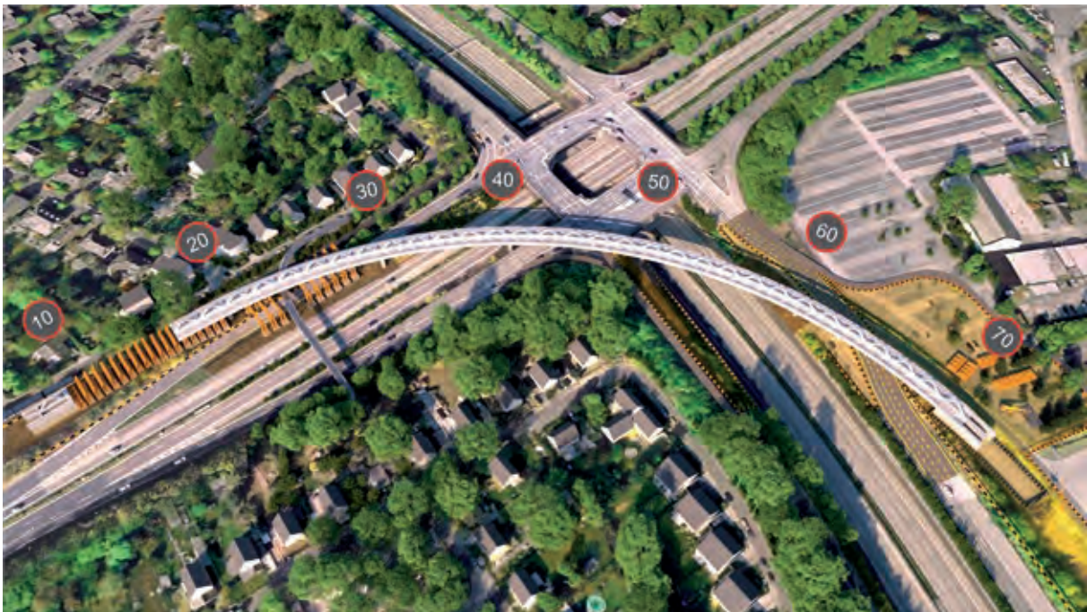
Bild 14 Vogelperspektive – Herstellung der Widerlager/Montage auf Traggerüsten
