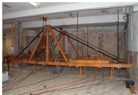
Bild 6 Widerlagerkonstruktion zum Lastabtrag; links: Untersuchungsbereich I (hier war ein zusätzlicher Querrahmen zur Verankerung des Widerlagers im Bestand notwendig, ganz links im Foto zu sehen); rechts: Untersuchungsbereich II
