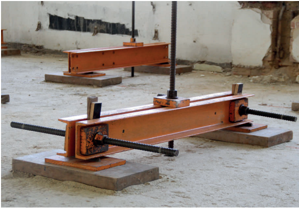
Bild 7 Lastverteilung auf der Deckenfläche; die Kraft aus einer Zugstange wird über die Stahltraverse in zwei Lasteinleitungspunkte geleitet Reformhohlsteindecke
