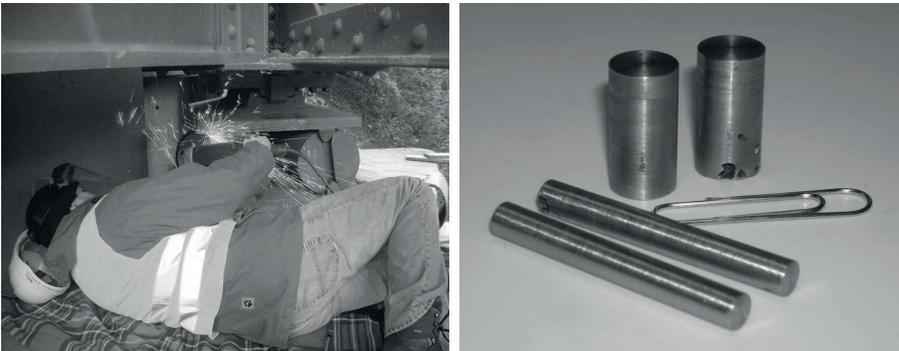
*Bild 1 In-situ-Probenentnahme (links); vorbereitete Druck-/Zugproben (rechts); gut sichtbar einige Lunker im Endbereich jeweils einer Druck- und Zugprobe*
