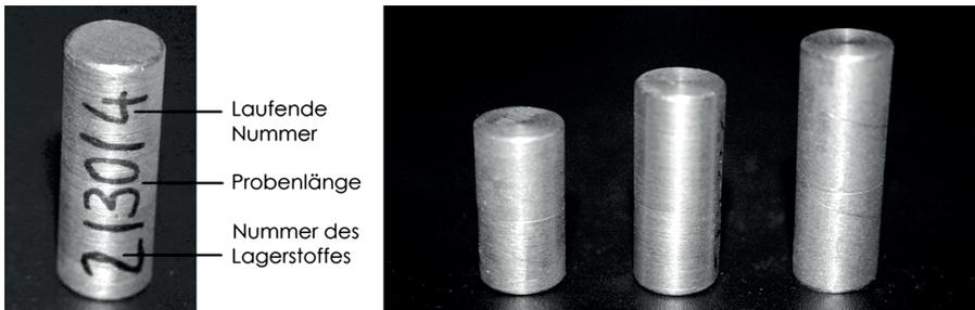
Bild 8 Bezeichnungsschlüssel (links) sowie unterschiedliche Probengeometrien (rechts)
