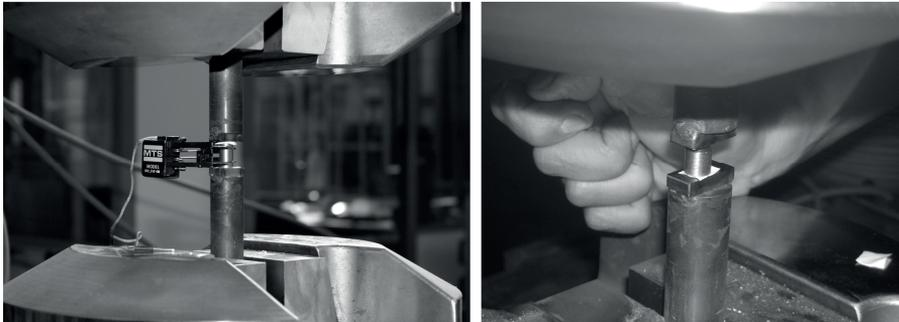
Bild 4 Versuchsaufbau – allgemein (links) sowie Detail mit Teflonlage (rechts)
