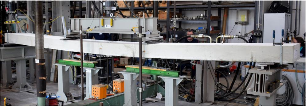
Bild 4: 4-Punkt-Biegeversuch an Plattenstreifen – hier: PK 3
