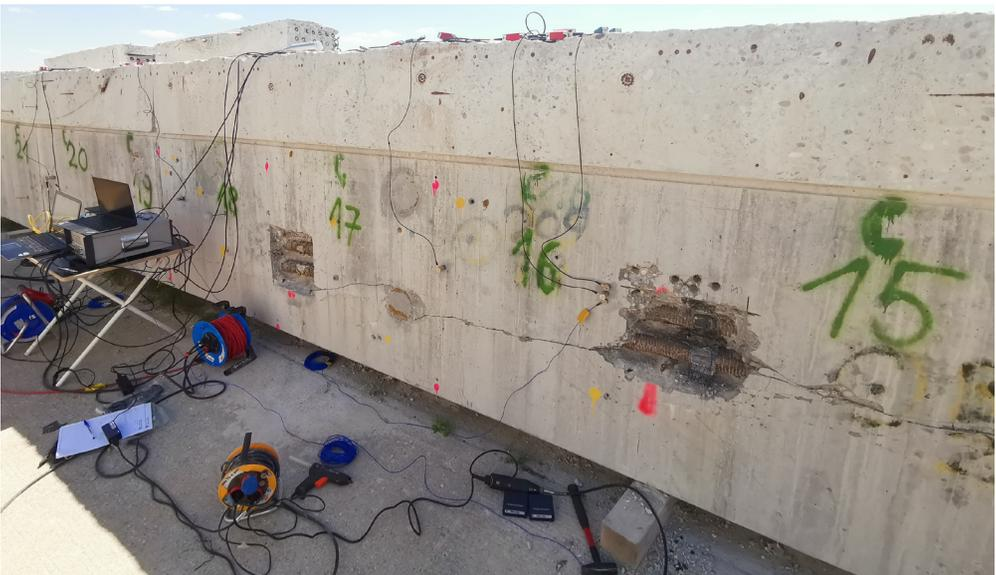
Bild 3: Trägerelement 1, Längsrisss im Bereich der Spannglieder
