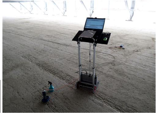
**Bild 6:** Prinzipskizze für Potentiostat und Messanordnung sowie Beispiel für praktische Anwendung in einem Parkhaus (Aufsatzmesszelle links unten)
