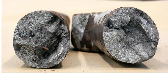
**Bild 4:** Im Bereich der Stabanschlüsse und -verbindungen wurden mitunter lokale Gefügeinhomogenitäten gefunden, die zu etwas verringerten Bruchwerten führen konnten
