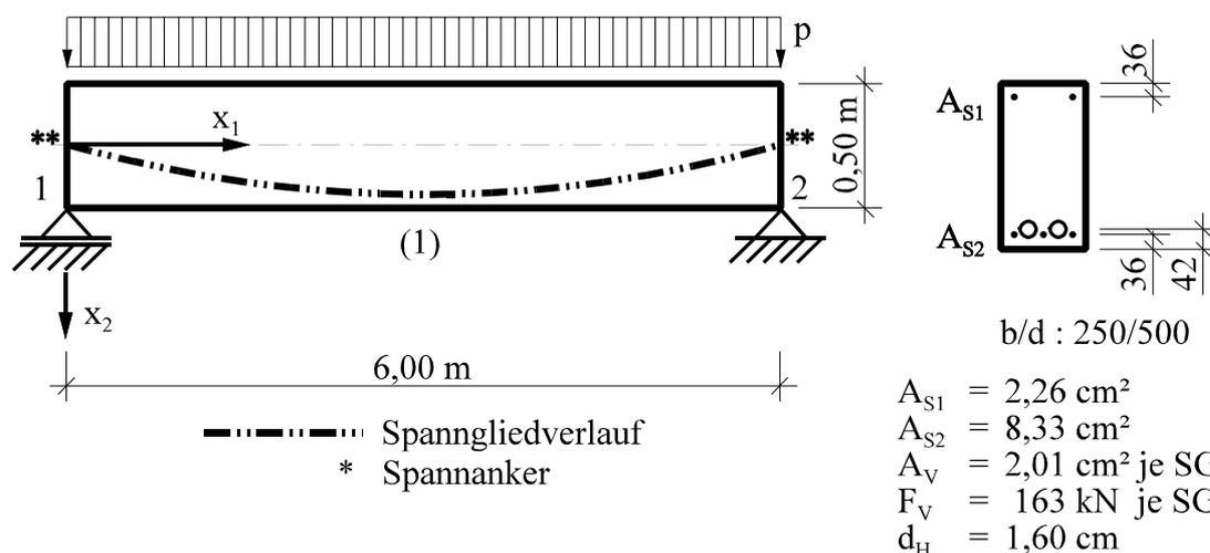
Der Stab wurde in 120 Integrationsabschnitte unterteilt, der Querschnitt durch 60 Schichten modelliert (verwendete Materialgesetze nach MA / BERTERO). Die Inkremente wurden von 8 kN/m mit zunehmender Last auf 0,08 kN/m verringert (insgesamt bis zum Systemversagen 114 statische Lastinkremente). Systemversagen wurde erreicht bei einer Lastgröße  $p_{\text{Trag}} = 76,8 \text{ kN/m}$ , Versuchsergebnis:  $p_{\text{Trag}} \approx 75,5 \text{ kN/m}$ .
