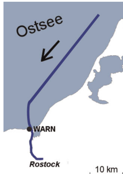
Abb. 2: Fahrtabschnitt des Vermessungsschiffes Deneb ausgewählt für kinematische PPP-Datenauswertung und Referenzstation Warnemünde (WARN), die für die Basislinienberechnung verwendet wurde
