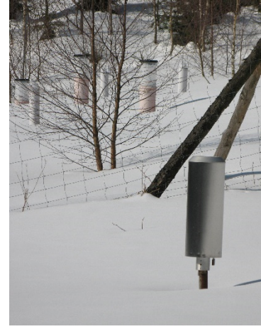
Niederschlagsmessung (vorn: Waage, hinten: Totalisatoren)
