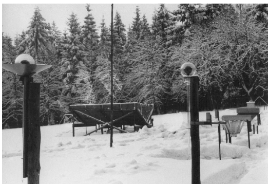
Strahlungsmessungen mit Kugelpyranometern nach Bellani, im Hintergrund große Messrinne für Niederschlag (Freilandmessung als Referenz für die Rinnen im Bestand), rechts Niederschlagsmesser, 1960er Jahre
