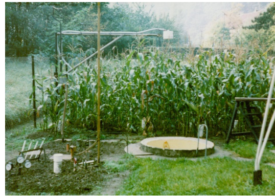
Messfeld mit Teilfläche „Bestand“ (Mais), darüber Strahlungsmessung, Bildmitte Brunnenschacht für Tensiometermessung, links Erdbodenmessfeld, ca. 1989
