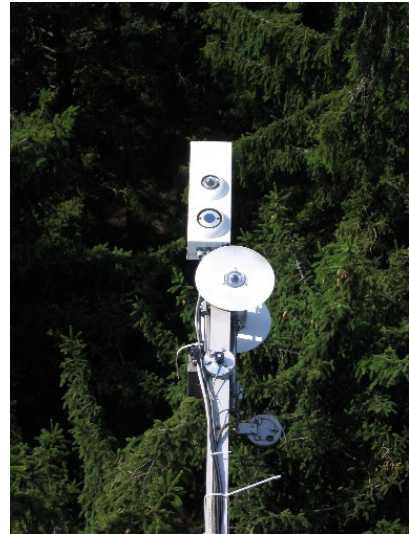
Strahlungsbilanzmessung am Messturm
