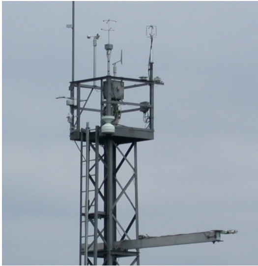
Messturm mit Anemometer, Strahlungsbilanz, Niederschlag und Ansaugschlauch für Gasanalysator ( \text{CO}_2/\text{H}_2\text{O} )
