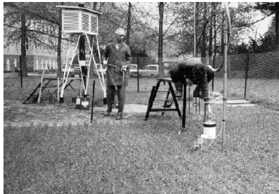
Bodenfeuchtemessung mit Neutronensonde, 1998, Bildmitte: Horst Hebentanz
