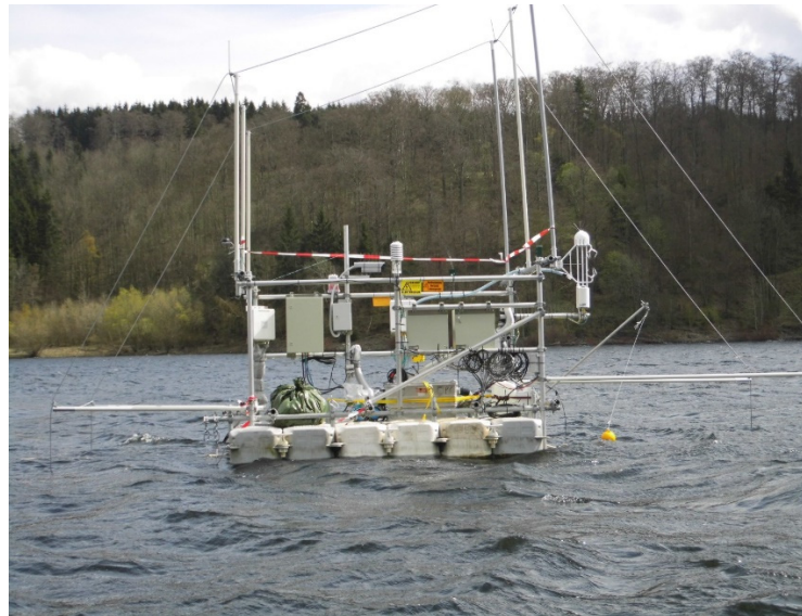
Schwimmende Messplattform, Talsperre Rappbode (im Rahmen von TREGATA, 2017)
