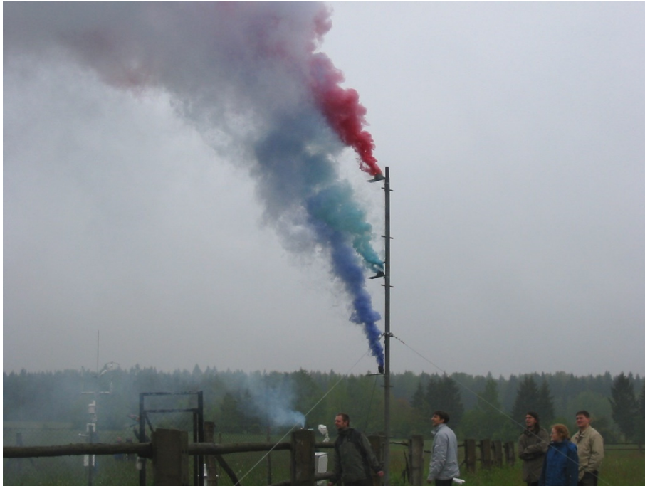
Tracerversuch in Grillenburg (im Rahmen von EU Marie-Curie TRACEFLUX, 2004)
