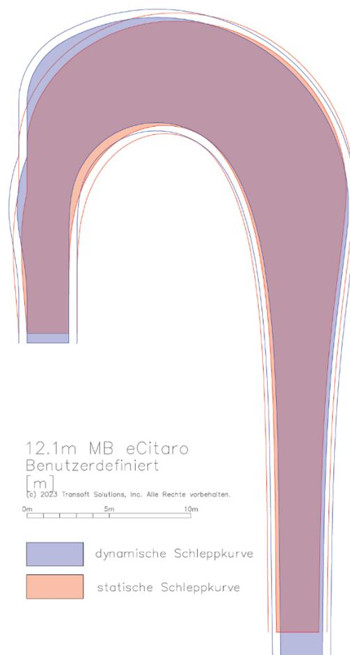
Abbildung 4.7: Schleppkurvenvergleich dynamisch - statisch, MB Citaro
