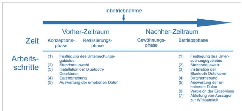
Abbildung 2: Konzept zum Nachweis der Wirkungsweise des Elbebrückeninformationssystems auf der Basis von Bluetooth
