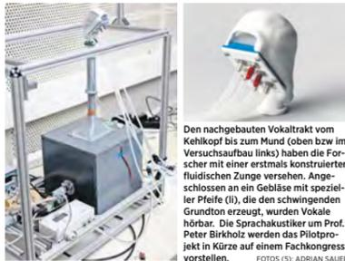
Den nachgebauten Vokaltrakt vom Kehlkopf bis zum Mund (oben bzw. im Versuchsaufbau links) haben die Forscher mit einer erstmals konstruierten flüssigen Zunge versehen...
