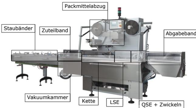
**Fig. 2:** Schlauchbeutelverpackungsmaschine FPC5 der Firma THEEGARTEN-PACTEC
