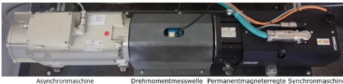
Fig. 1: Maschinen-Prüfstand bei M&P mit zwei ca. 15 kW betrieben an M&P 3-Level-Stromrichtern (LT300-ML) / M&P machine testrig with two machines
