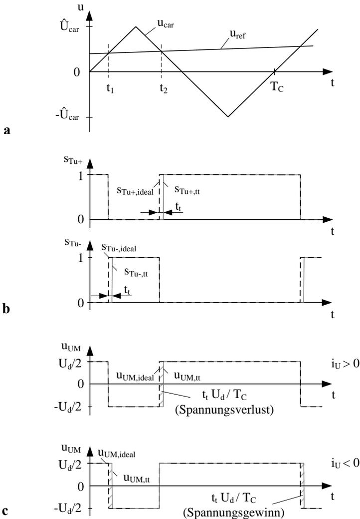
**Abb. 2.57** Ausgewählte Spannungsverläufe einer Halbbrücke ohne und mit Berücksichtigung einer Totzeit  $t_t$  für beide Stromflussrichtungen. **a** Referenzspannung und Trägersignal **b** Schaltsignale von  $T_{U+}$  und  $T_{U-}$ ; schwarz gestrichelt: ohne  $t_t$ , grau: mit  $t_t$  **c** Mittelpunktspannung  $u_{UM}$ ; schwarz gestrichelt: ohne  $t_t$ , grau: mit  $t_t$
