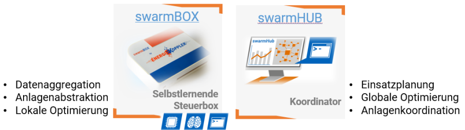
Bild 1: Die Komponenten des Flexibilitätswerks mit wesentlichen Funktionalitäten
