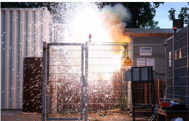
Störlichtbogenvorführung am NARC Foto: Sebastian Krahrmer
