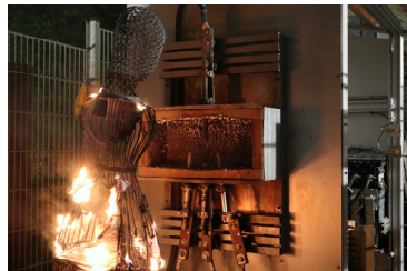
Testdummy nach Störlichtbogeneinwirkung Foto: Sebastian Krahrmer
