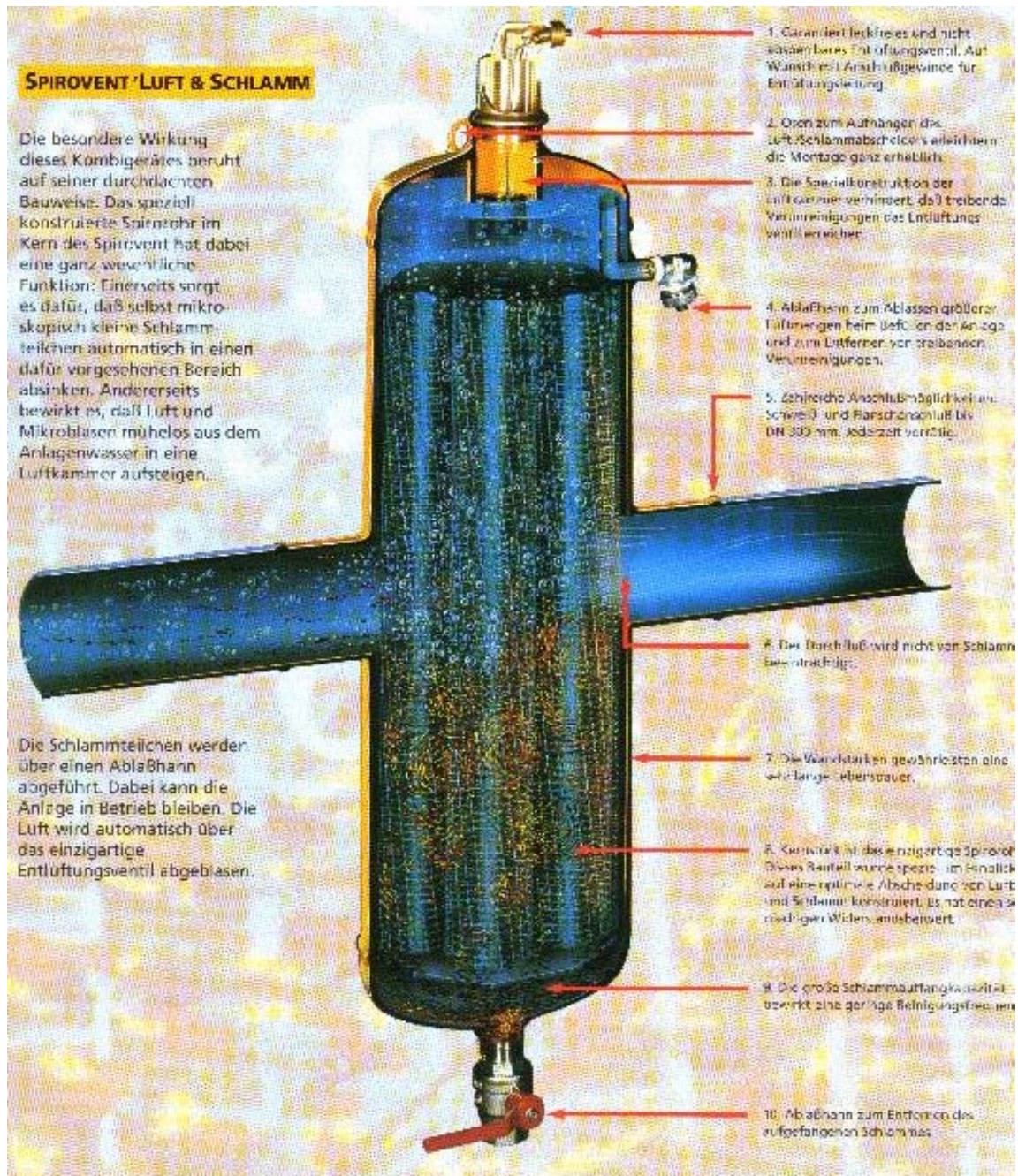
Abbildung 4-3 Aufbau Mikroluftblasen-Abscheider; Bsp. Spirovent
