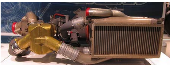
Aktuell eingesetzte per Zapfluft angetriebene Flugzeugklimaanlage (Quelle: Wikimedia Commons).
