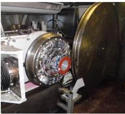
In Zusammenarbeit mit der GHH Radsatz GmbH wurde im Rahmen zweier Diplomarbeiten ein Messrad entwickelt und die Funktion mit Hilfe von statischen und dynamischen Prüf-
