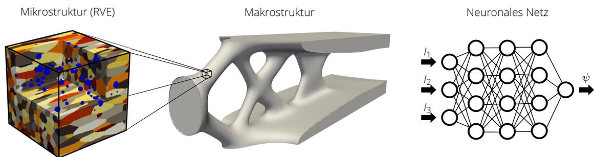
Abbildung 1: Datengetriebenes Multiskalenschema für Metalle mit ausgeprägter Korn-Mikrostruktur. Von links nach rechts: Mikrostruktur eines additiv gefertigten Metalls, makroskopische Struktur und konstitutives KNN als Materialmodell.
