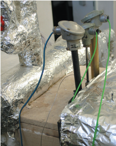
Bild 3: Einbausituation der Thermoelemente
