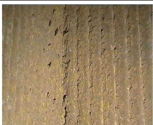
Abb. 4. Beläge auf einer Membranverdampferwand.
