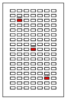
Abb. 3: Positionen der Temperaturund Feuchtemessung sowie der Bestimmung der Trocknungsgeschwindigkeit.
