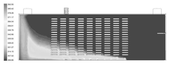
Abb. 6: Ist-Zustand, Temperaturprofil in [K], Längsschnitt Kammer, Rückwärtsbetrieb.
