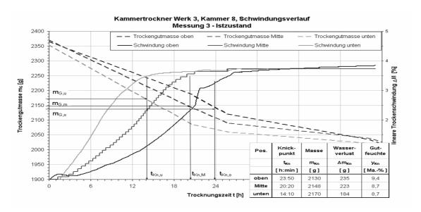
Abb. 7: Ist-Zustand, Gemessener Temperatur und Schwindungsverlauf im oberen, mittleren und unteren Bereich der Kammer.
