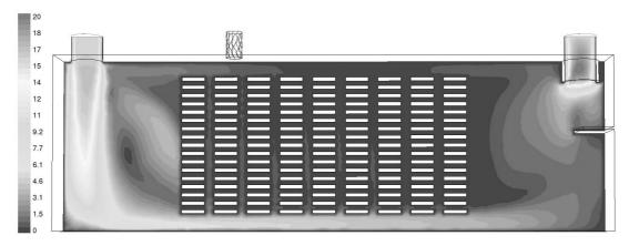
Abb. 4: Ist-Zustand, Geschwindigkeitsprofil in [m/s], Längsschnitt Kammer, Vorwärtsbetrieb.
