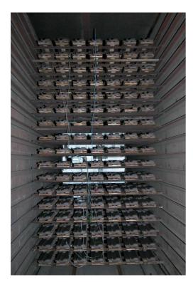
Abb. 2: Ansicht teilbefüllte Kammer mit installierter Messtechnik.
