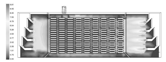
Abb. 8: Optimierung, Geschwindigkeitsprofil in [m/s], Längsschnitt Kammer, Rückwärtsbetrieb.
