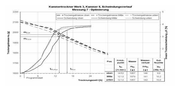
Abb. 9: Optimierung, Gemessener Temperatur- und Schwindungsverlauf im oberen, mittleren und unteren Bereich der Kammer.
