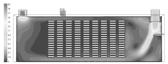
Abb. 5: Ist-Zustand, Geschwindigkeitsprofil in [m/s], Längsschnitt Kammer, Rückwärtsbetrieb.
