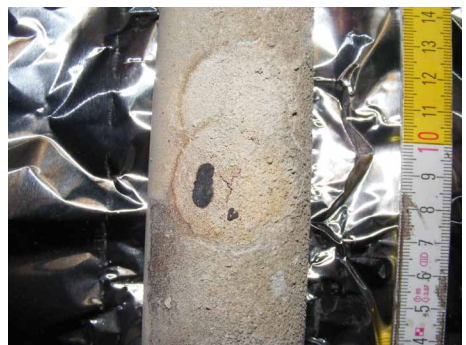
b) Abplatzungen und Risse – Sonde Nr. 2
