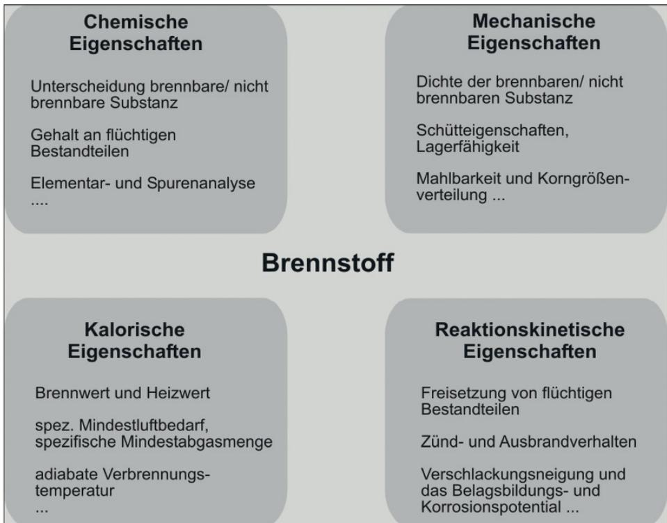
Bild 1: Brennstofftechnische Eigenschaften zur Charakterisierung von Brennstoffen
