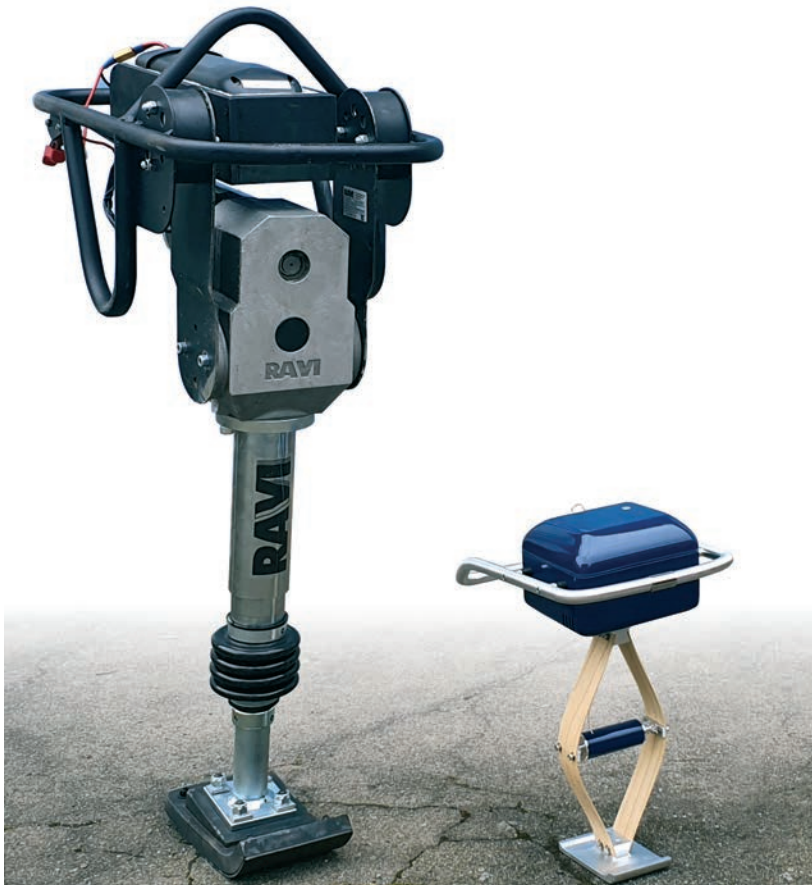
Elektrisch angetriebener Vibrationsstampfer (links) und Demonstrator für einen Stampfer mit Drachenviereckmechanismus im Compliantdesign (rechts)
