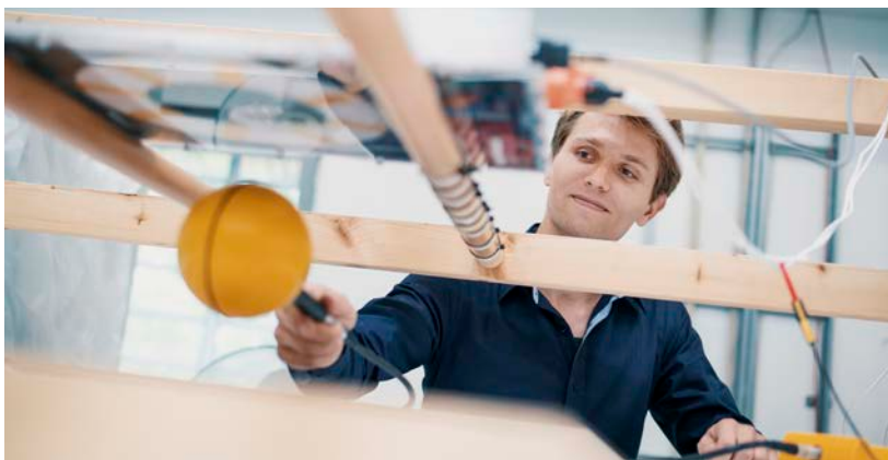
Messung des elektromagnetischen Feldes von induktiven Ladesystemen auf dem HiL-Teststand des ILK
