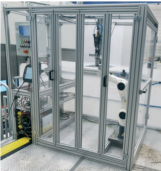
Automatisierte Fertigungszelle für den 3D-Druck von endlosfaserverstärkten duroplastischen Verbundbauteilen
