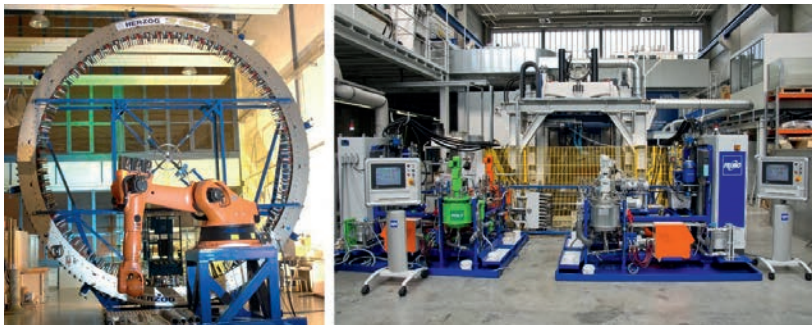
Das Radialflechtrad (links) und die HD-RTM-Infiltrationsanlage (rechts) des ILK werden zur Herstellung der Prüfplatten und -strukturen eingesetzt
