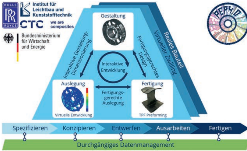
Abb. 1: Interaktiver Entwicklungsprozess mit den Einzeldisziplinen Konstruktion, Auslegung und Fertigung (oben) entlang der Phasen von der Spezifikation der Anforderungen bis zur Fertigung (unten)
