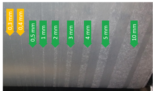
Selektives Testmuster zur Überprüfung der Auflösung des Binderauftrags.
