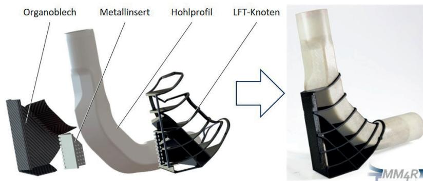
Generische FuPro-Struktur: Bauweise und gefertigtes Bauteil.
