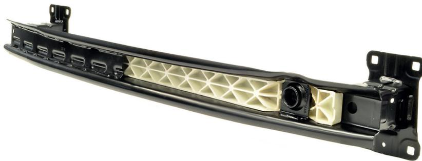
Crashmanagementsystem (CMS) mit hybridisiertem Stoßfängerquerträger bestehend aus warmumgeformten Stahlprofilen und einer lokalen Rippenstruktur hergestellt aus duroplastischer Pressmasse (SMC) für die mittlere und hohe Leistungsklasse.
