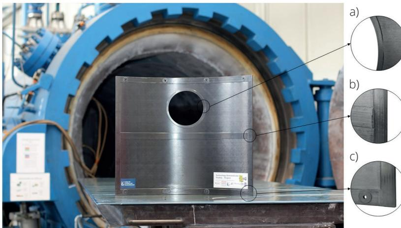
Mittels Autoklavprozess hergestellter Technologiedemonstrator mit a) Montagelochverstärkung, b) Rahmenverstärkung und c) Bohrlochverstärkung.
