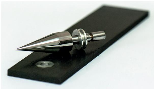
Abb. 01: FKV-Probekörper mit eingeförmtem Insert und Dornspitze.
