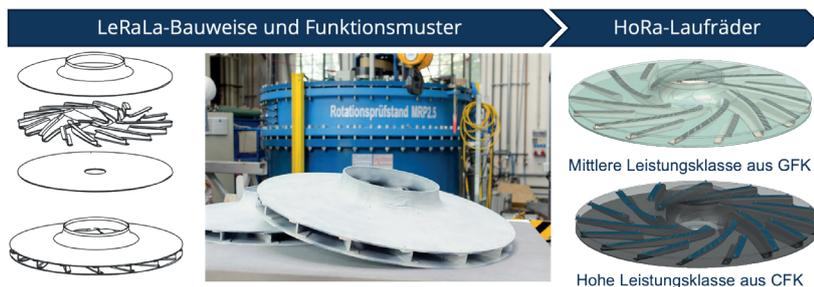
Verwendung der Erkenntnisse des LeRaLa-Projekts und Weiterentwicklung der Bauweise für die mittlere und hohe Leistungsklasse.
