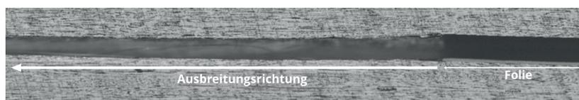
Abb. 03 Typische Delaminationsform für 0°/0°-Schichtinterface.
