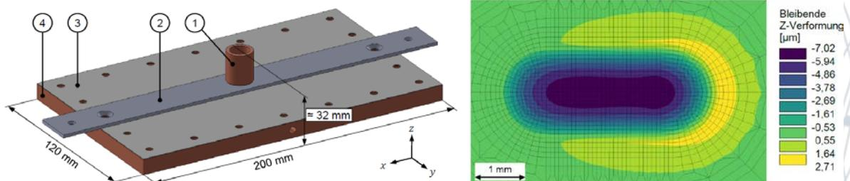
*Vereinfachte Geometrie des entwickelten 3DFinite-Elemente-Modells (links), simulierte bleibende Verformung nach Translationsbewegung der Elektrode auf dem Blech (rechts); entnommen aus Diplomarbeit J. Grunwald, IMD, LWM, TU Dresden, 2023*
