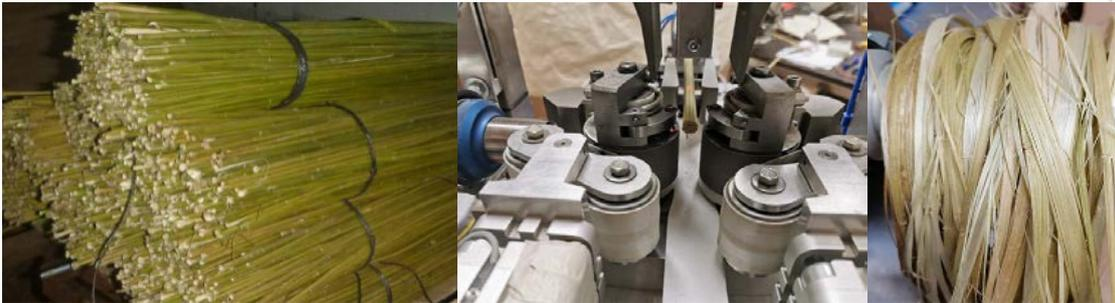
Links: Hanfstängelbündel; Mitte: Vorrichtung für das Schälen einzelner Hanfstängel; rechts: von Stängeln getrennte Hanfbaststreifen
