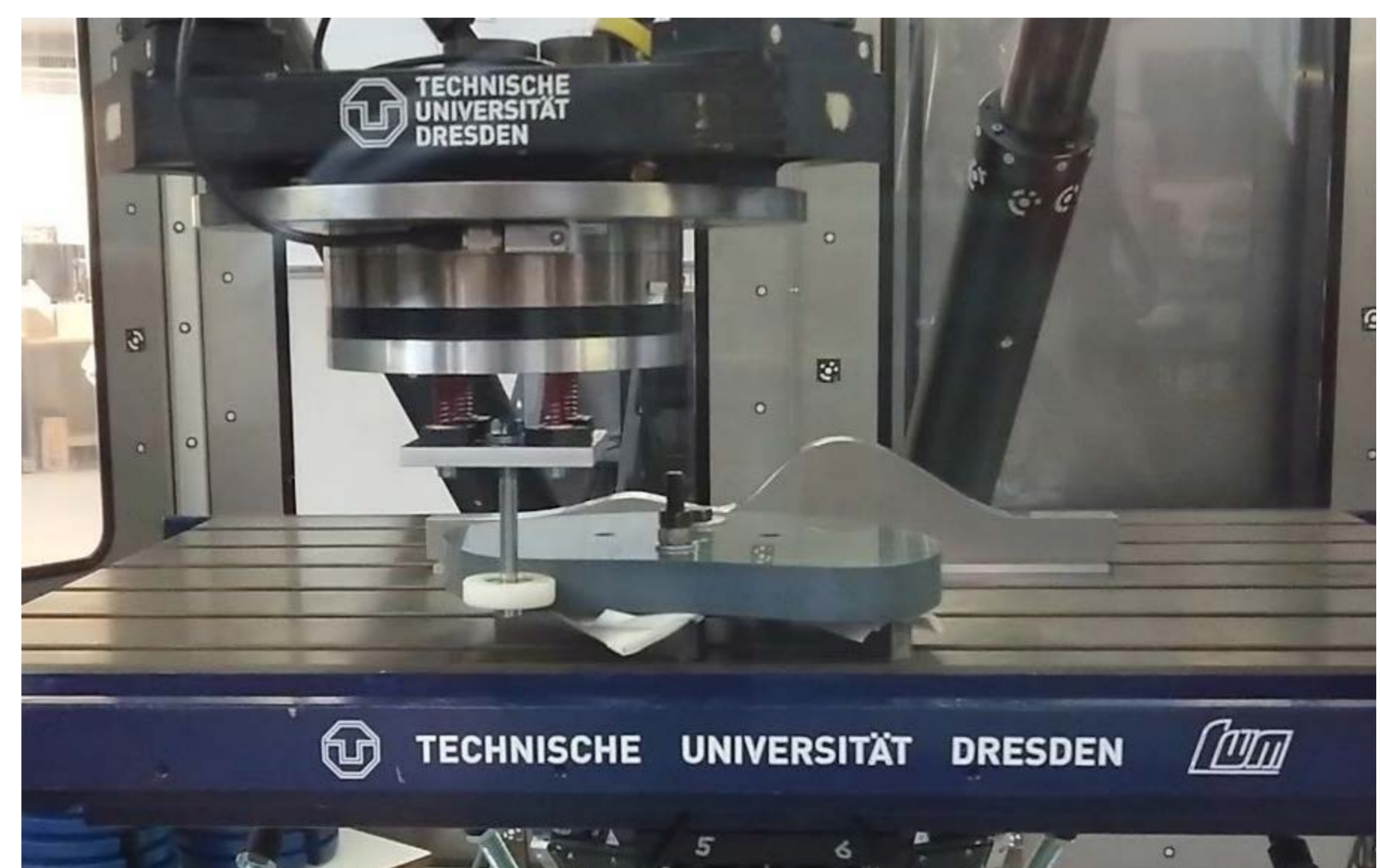
Abb. 2: Versuchsaufbau für die in Abb.1 gezeigte horizontale Konturverfolgung in Oberflächennormalenrichtung
