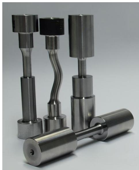
Am IMM stehen zur Prüfung gekerbter Bauteile im Dauer- und Zeitfestigkeitsbereich verschiedene Prüfmaschinen zur Verfügung. Zug, Druck, Torsion und Biegung können mit Hilfe dieser servo-hydraulischen Prüfstände realisiert werden. Anschließend kann auf Basis von Treppenstufenversuchen auf die Tragfähigkeit des Bauteils geschlossen werden.
