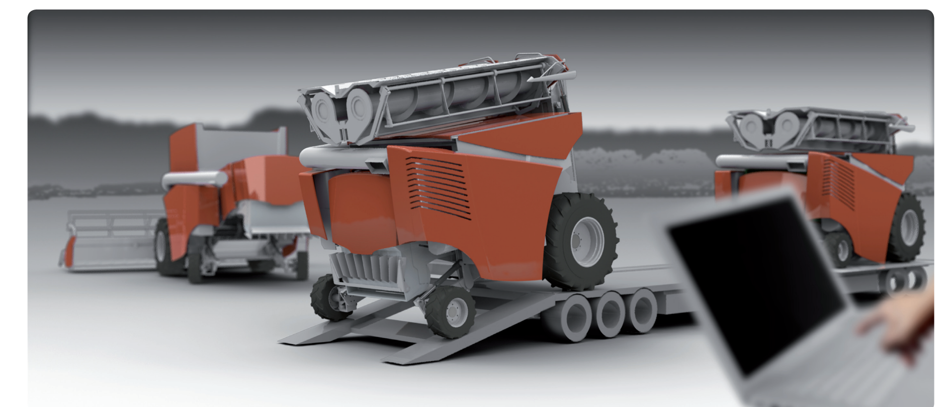
Entladevorgang der autonomen Ernteeinheiten vom Transportsystem
