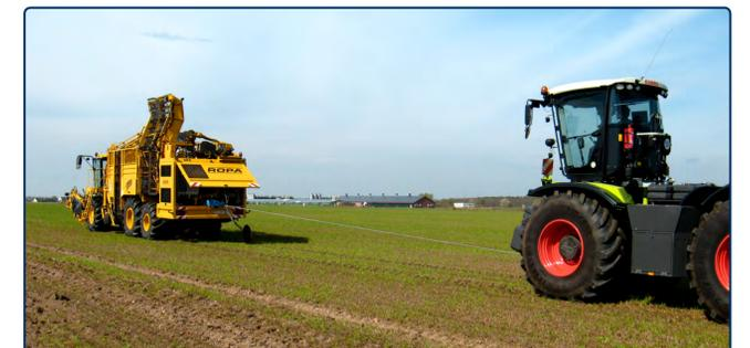
Zugkraftmessung mit Claas Xerion 4500 als Bremsmaschine
