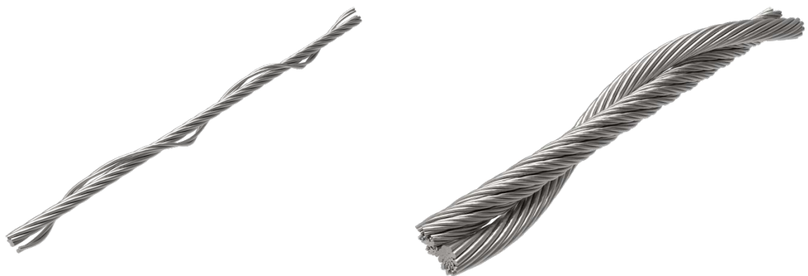
Abbildung 99: Kernlitze mit weiterem Draht in einfacher Helix und zusätzlichem Draht in doppelter Helix (links) und kompletter Seilkern mit einer Außenlitze (rechts)
