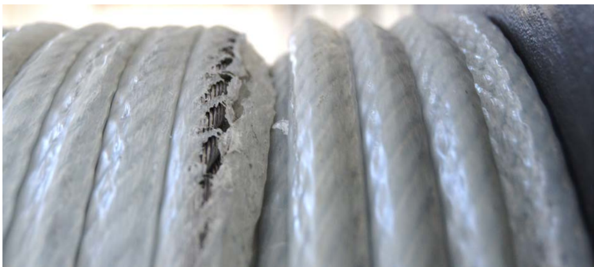
Abbildung 48: Schädigung des Kunststoffmantels bei 25 kN Prüfkraft durch Wickelfehler
