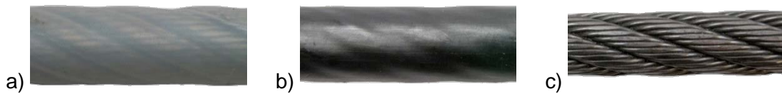
Abbildung 2: Seilvarianten; a) Seilvariante 1 (durchsichtig, transparent); b) Seilvariante 2 (schwarz); c) Seilvariante 3 (konventionell)
