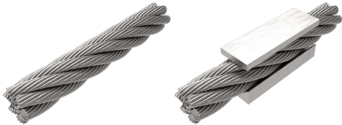
Abbildung 100: Vollständiges IWRC Seil (links) und Seil mit Prüfbacken für Querelastizitätsversuch (rechts)
