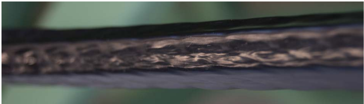
Abbildung 43: Sechseckig deformierter Kunststoffmantel im Parallelbereich einer höheren Lage
