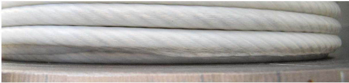
Abbildung 45: Geschädigtes Seil durch fehlenden Bordscheibenkontakt auf der Trommel
