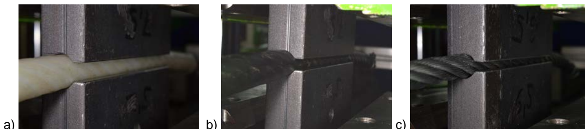
Abbildung 55: Querdruckversuche; a) Seilvariante 1; b) Seilvariante 2; c) Seilvariante 3
