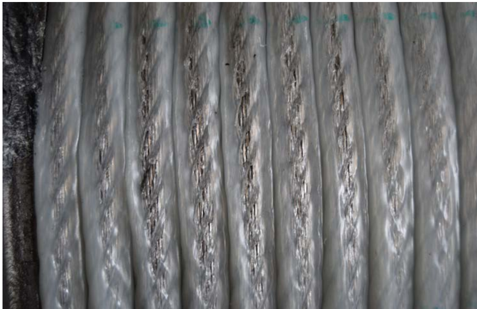
Abbildung 40: Offener Kunststoffmantel im Kreuzungsbereich bei Auflage auf der Seiltrommel
