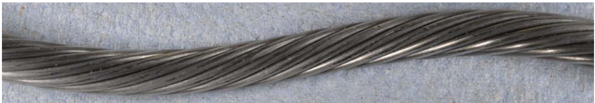
Abbildung 58: Innerer Zustand nach Querdruckprüfung; Seilvariante 2; F = 75 \text{ kN}
