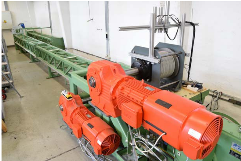
Abbildung 33: Spulprüfstand mit elektrischen Antrieben
