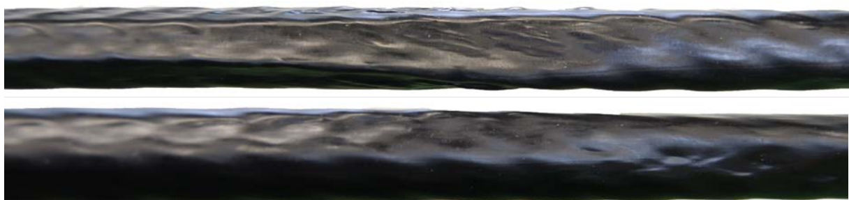
Abbildung 36: Deformation der zweiten (oben) und der vierten Lage (unten) nach zweimaligem spulen auf der Seiltrommel D/d = 18
