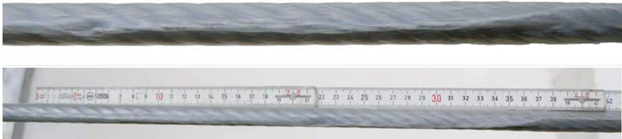
Abbildung 46: Grat am Seil im Detail (oben) und mit Maßstab (unten)
