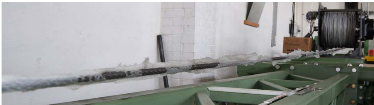
Abbildung 38: Kunststoffmantel nach 20-maligem spulen bei 25 kN und D/d = 25
