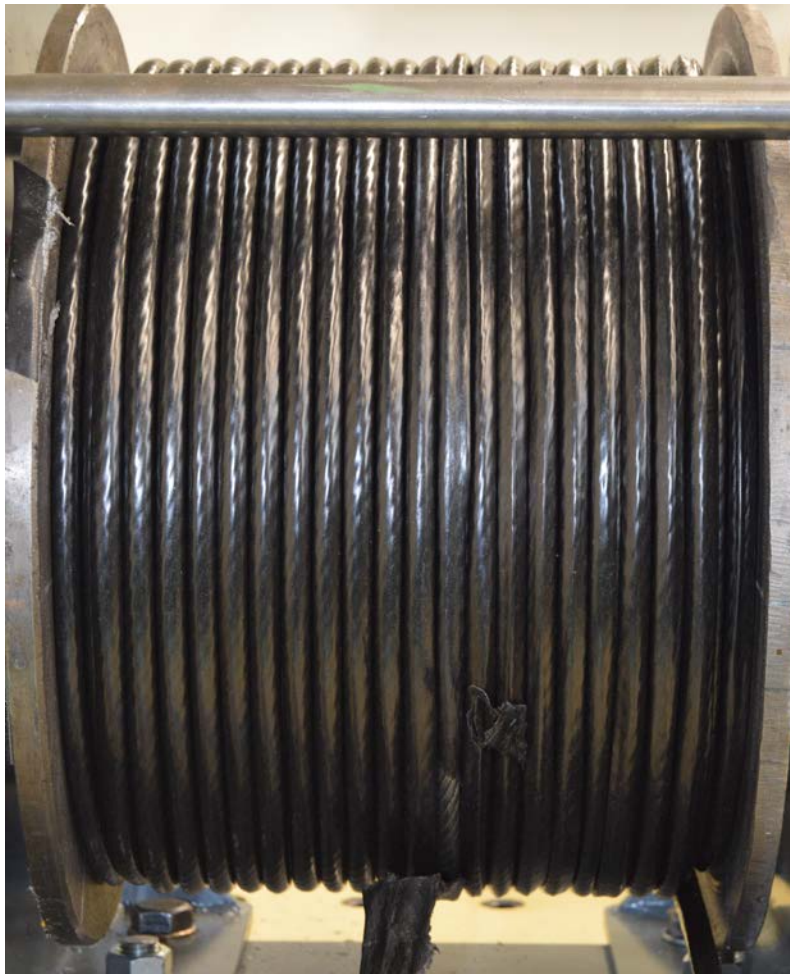
Abbildung 53: Wickelbild nach 550 Spulvorgängen von Kunststoff 2 bei einem D/d-Verhältnis von 24 und einer Prüflast von 10 kN
