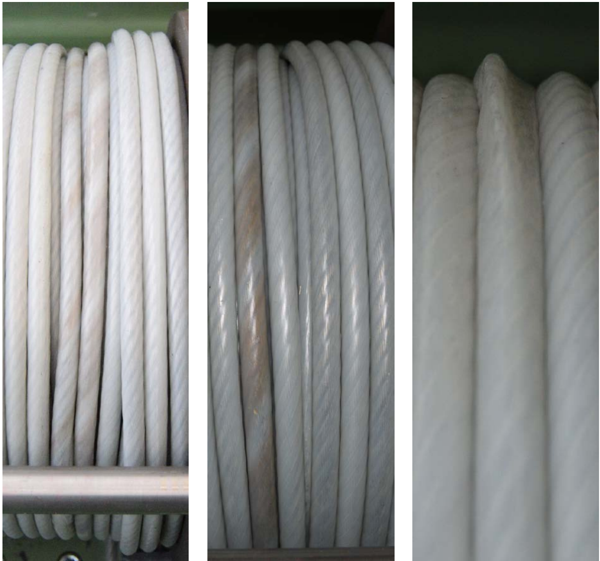
Abbildung 47: Auswirkungen (links) eines Wickelfehlers (Mitte) durch einen Grat in der unteren Lage (rechts).
