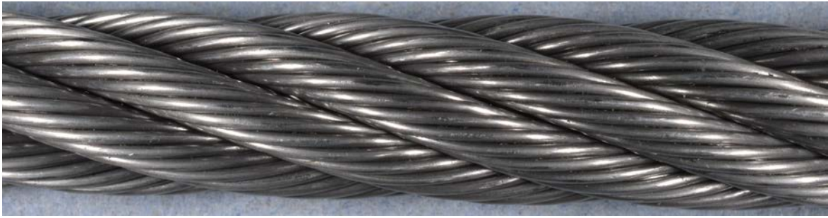
Abbildung 57: Äußerer Zustand nach Querdruckprüfung; Seilvariante 2; F = 75 \text{ kN}
