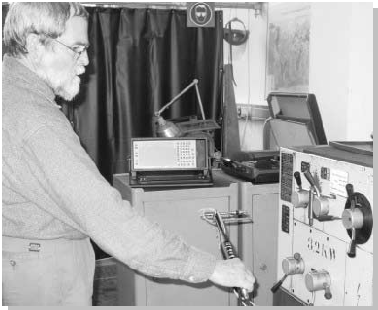
Schallintensitätsmessung an einer Drehmaschine
