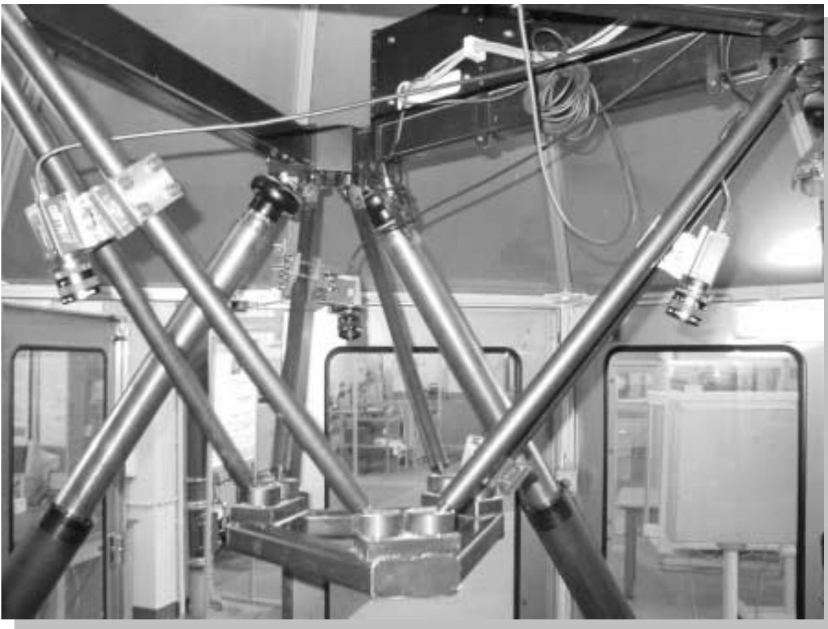
Kamera-Anordnung zur Bilderkennung am Hexapoden
