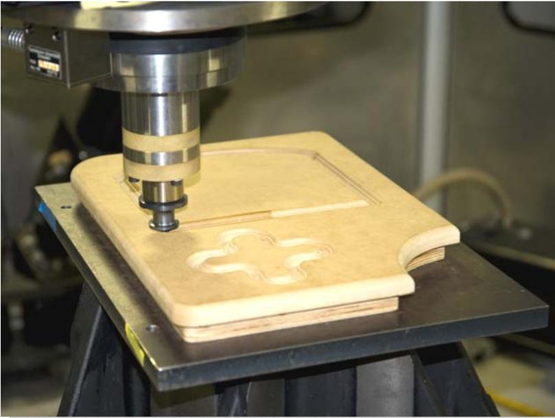
*Bild 1: Thermoglätten des Innenprofils einer MDF Faserplatte*
