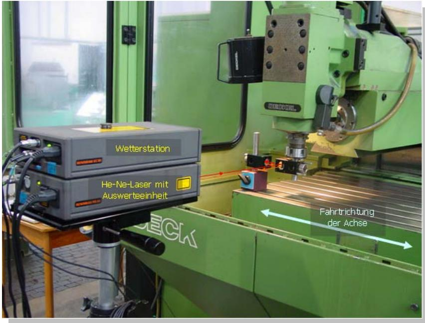
*Laser-Interferometer bei einer linearen Verschiebungsmessung*
