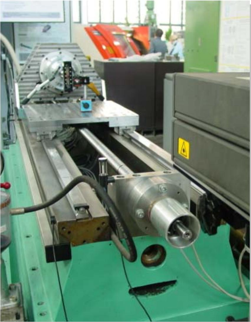
*Vorschubachse mit Kugelgewindetrieb*
