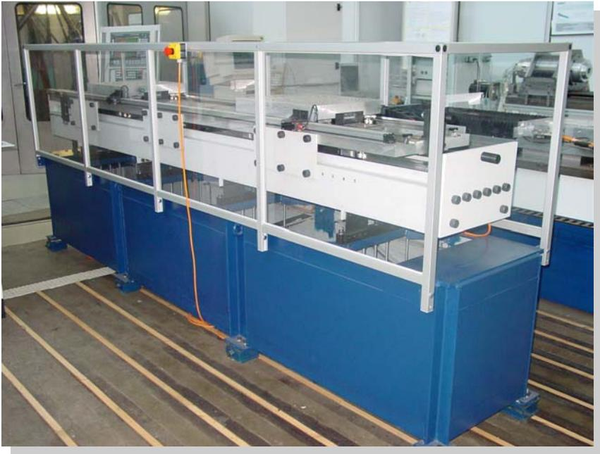
*Bild 2: Prüfstand zur Impulskopplung*
