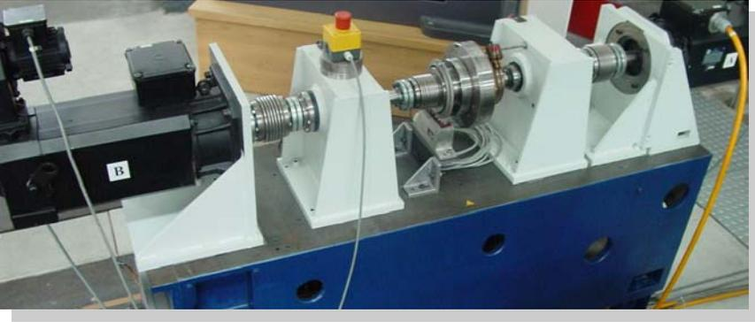
*Ansicht des Kupplungsprüfstandes*
