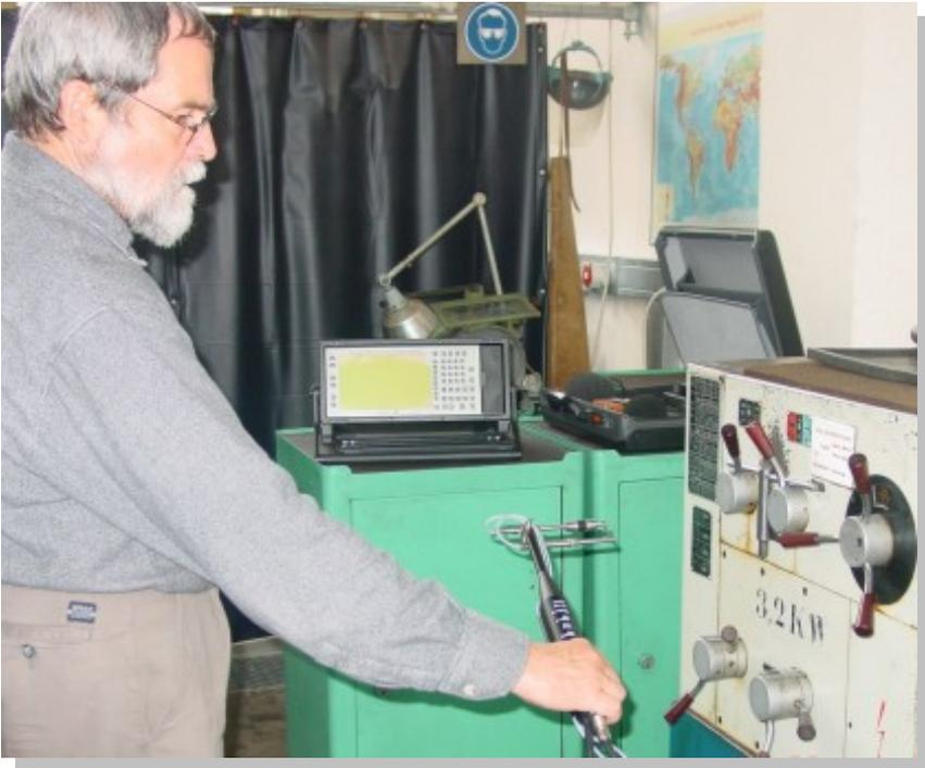
*Schallintensitätsmessung an einer Drehmaschine*
