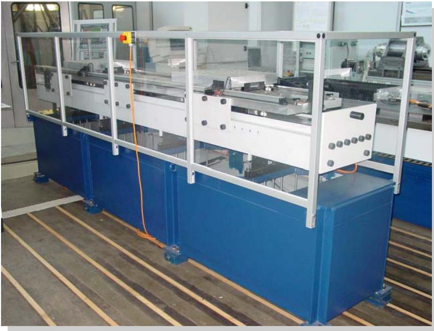
Versuchsstand Impulskompensation und -entkopplung
