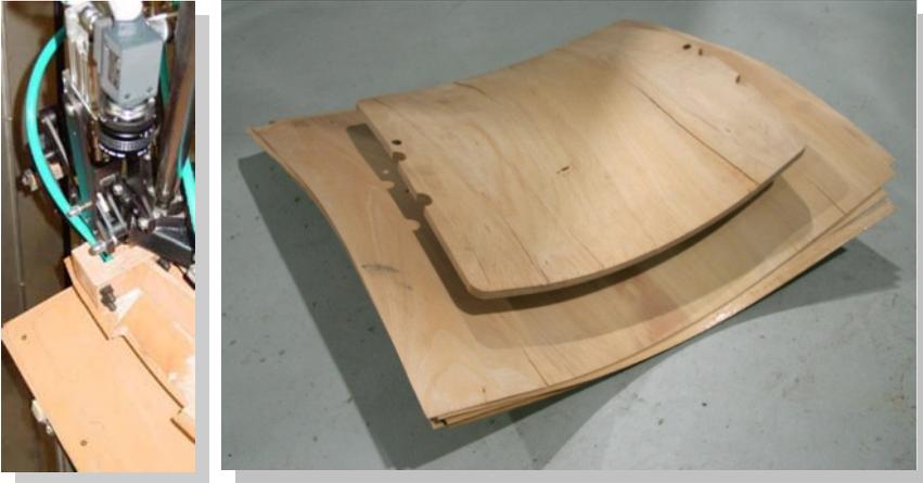
Bildverarbeitung / Rohling und bearbeitetes Werkstück
