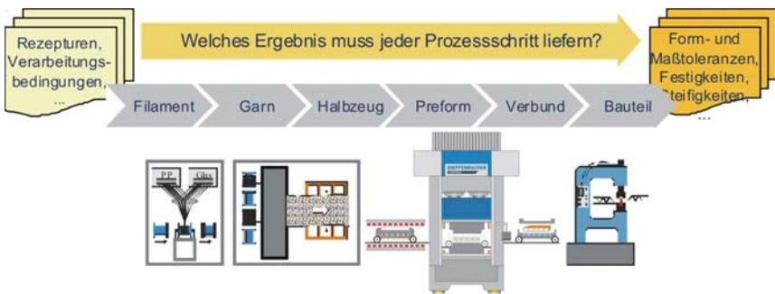
*Bild 1: Problemstellung der Prozesskettenmodellierung:
