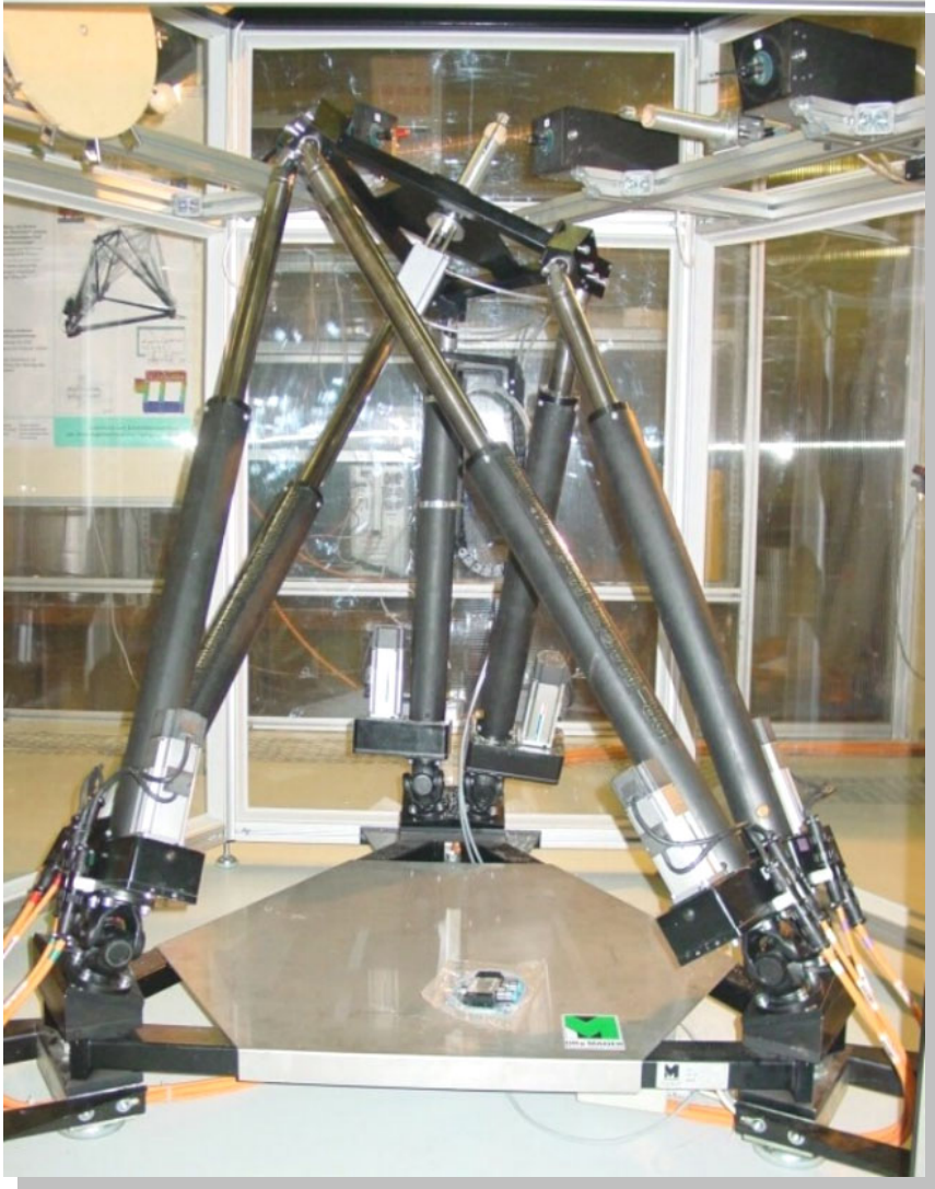
MiniHex bei der Bearbeitung von Holzkugeln
