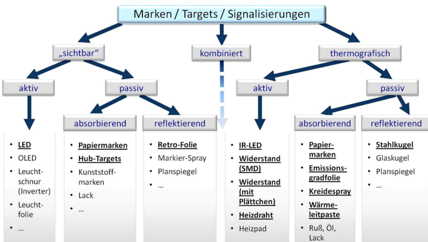
Bild 1: Einteilung von Signalisierungen für Nahbereichsfotogrammetrie und selektive Thermografie
