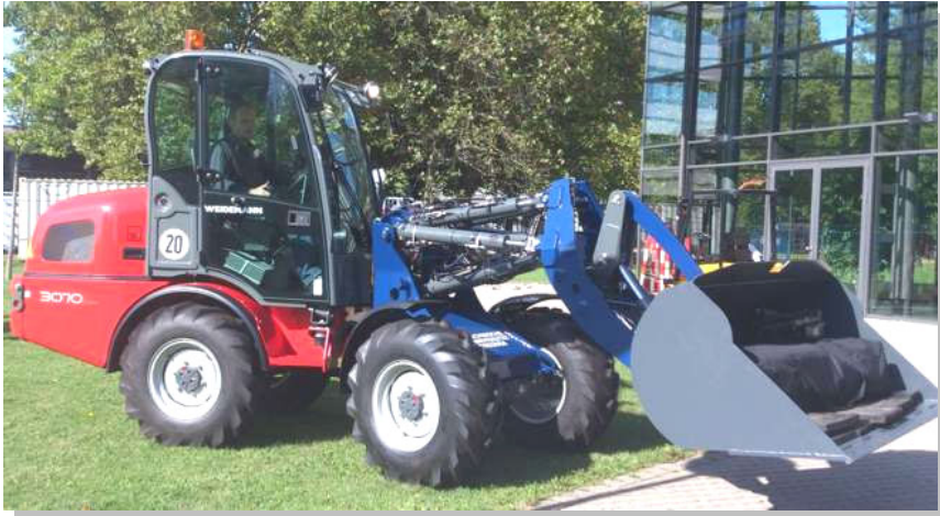
Bild 3: Demonstrator-Radlader mit Hexapodarbeitsausrüstung
