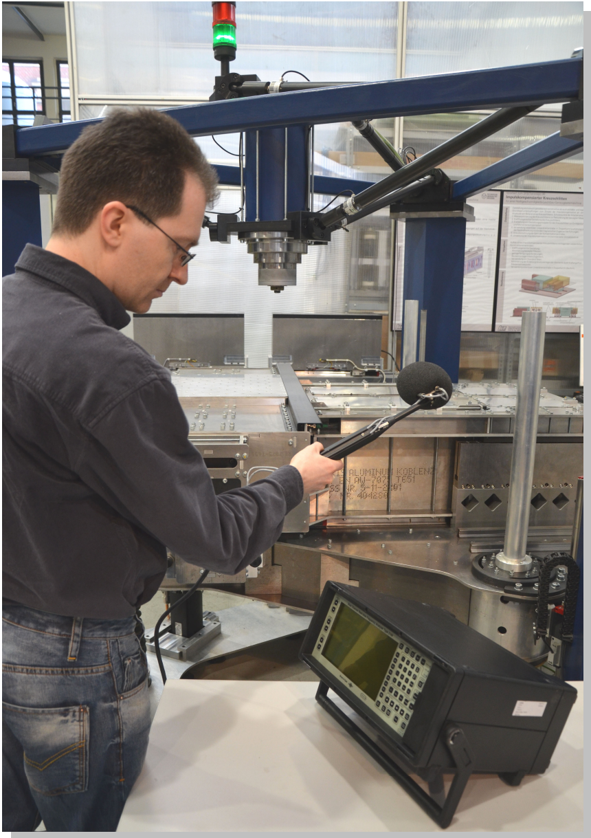
Schallintensitätsmessung am Versuchsträger MAX
