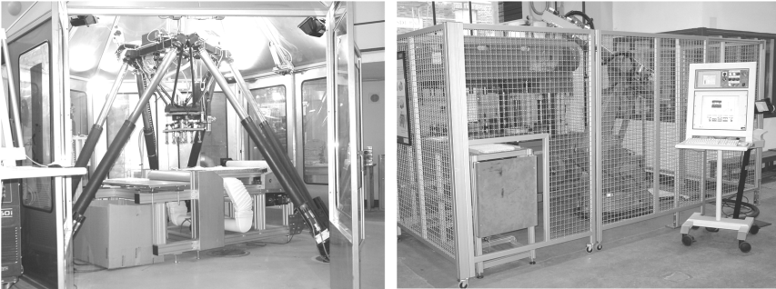
Bild 4: Bearbeitungscentren links: Preformherstellung (BAZ 1), rechts: Fertigteilherstellung (BAZ 2)
