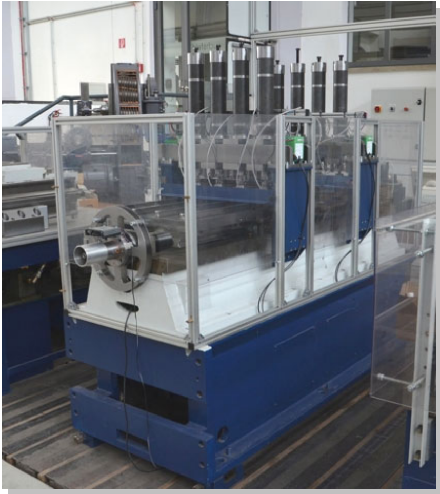
Lebensdauerprüfstand für PSF "bewegte Schienen"
