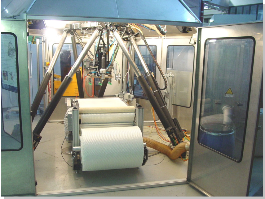
Hexapod mit Ausrüstung für Plasmaschneiden und Handling von Hybridgarn-Textil-Thermoplast (HGGT)-Halbzeugen
