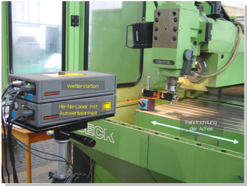
Laser-Interferometer bei der Ermittlung der Positionierunsicherheit
