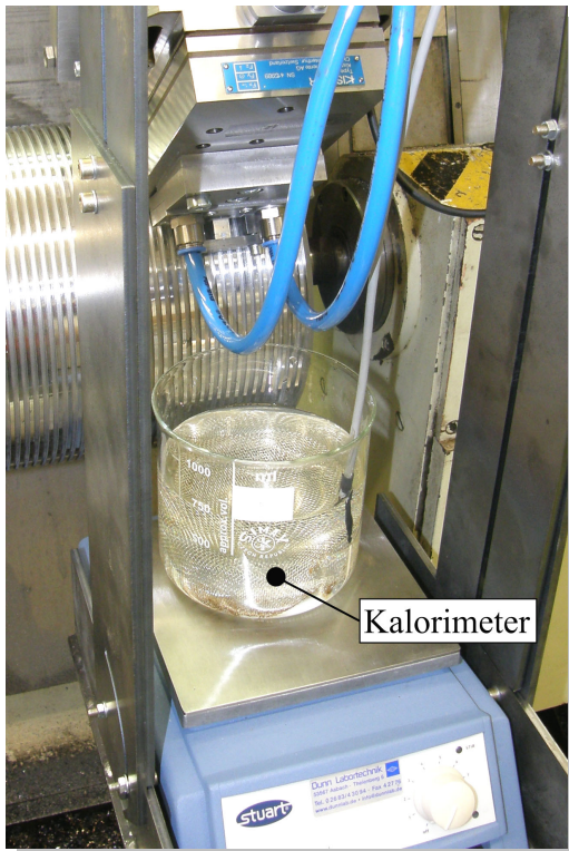
Bild 1: Versuchsaufbau – Erfassung des Spananteils des Wärmestromes
