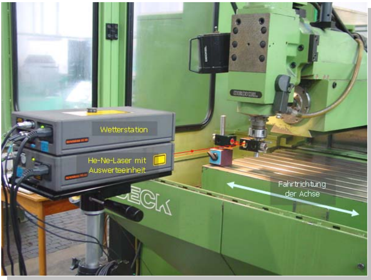
Laser-Interferometer bei einer linearen Verschiebungsmessung
