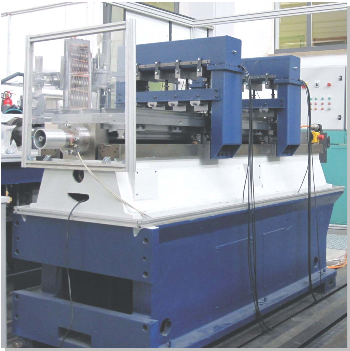
Bild 2: Laufversuche auf dem Versuchsstand mit bewegter Prüflingsschiene
