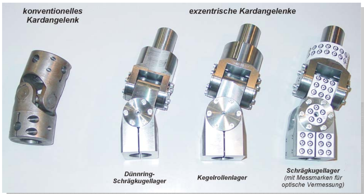
Bild 4: Konventionelles Kardangelenke und neu entwickelte exzentrische Gelenke
