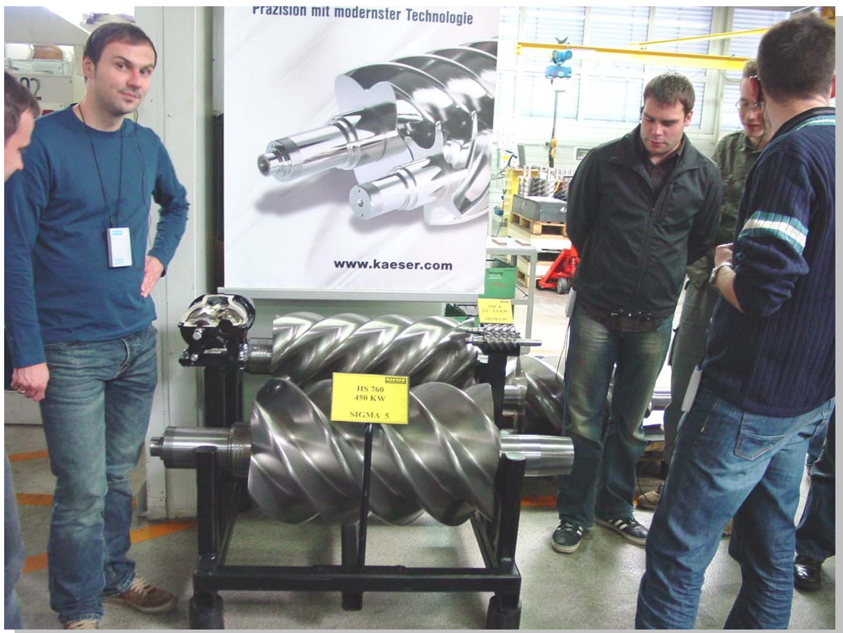
Das Innenleben von Schraubenkompressoren
