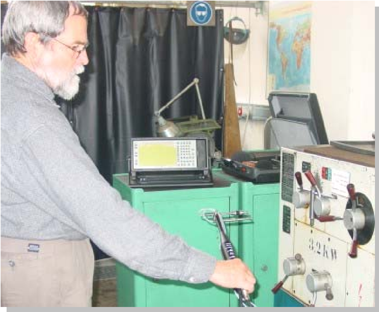
Schallintensitätsmessung an einer Drehmaschine
