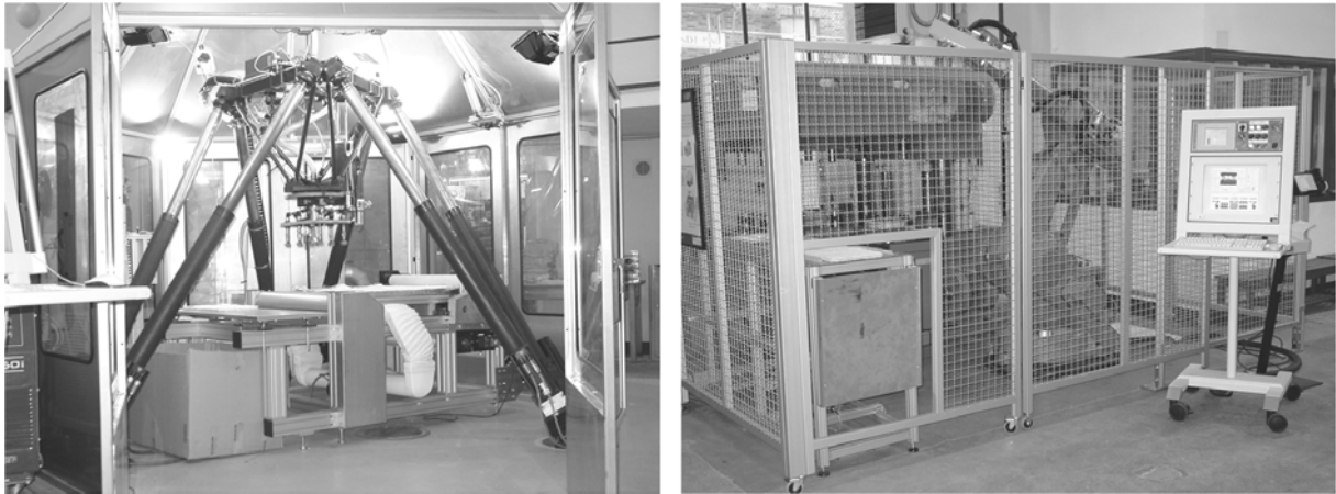
Bild 4: Bearbeitungszentren links: Preformherstellung (BAZ 1), rechts: Fertigteilherstellung (BAZ 2)
