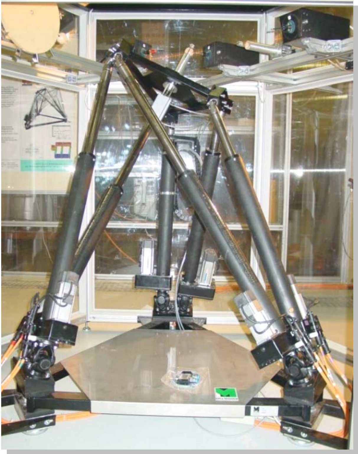
MiniHex bei der Bearbeitung von Holzkugeln
