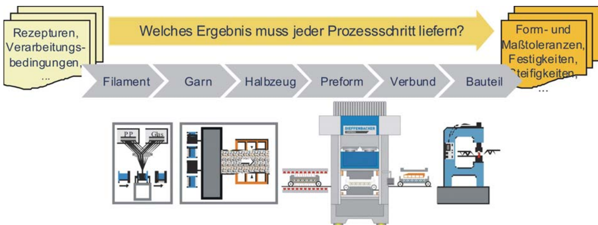
Bild 1: Problemstellung der Prozesskettenmodellierung: Erfassung aller relevanten Einflüsse auf die reproduzierbare Herstellung der geforderten Bauteileigenschaften
