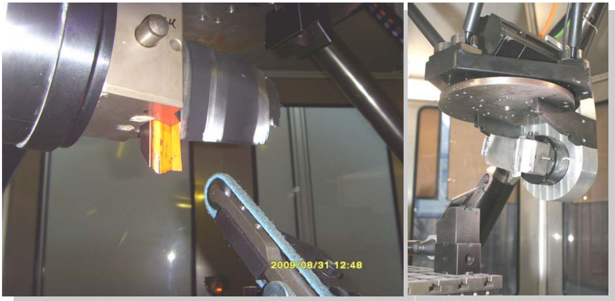
Bild 3: Drehachse für die Turbinenschaufel (links) und deren Anordnung an der Plattform (rechts)
