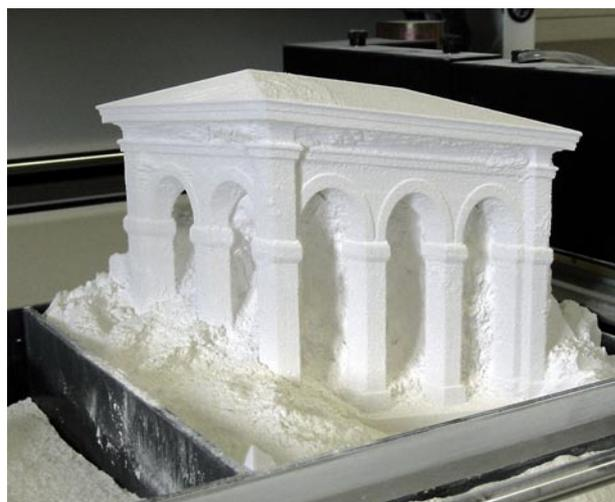
Abb. 4: Bergen des Modells aus dem 3D-Drucker
