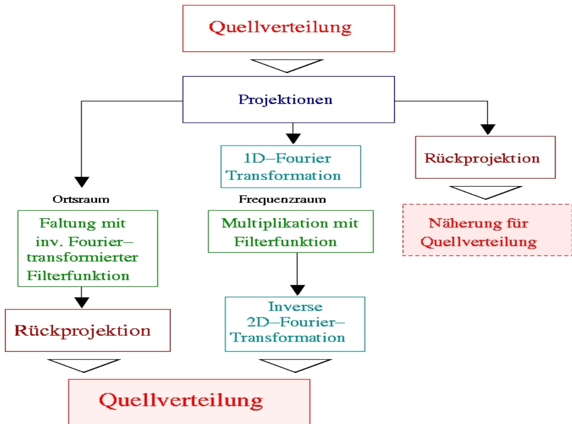
Abb. 6: Schematische Darstellung der einfachen und gefilterten Rückprojektion [1]
